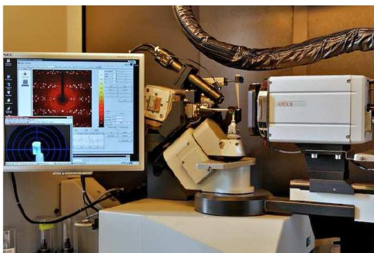
**Figure I-2:** *Diffractomètre automatique Bruker Apex II.*
