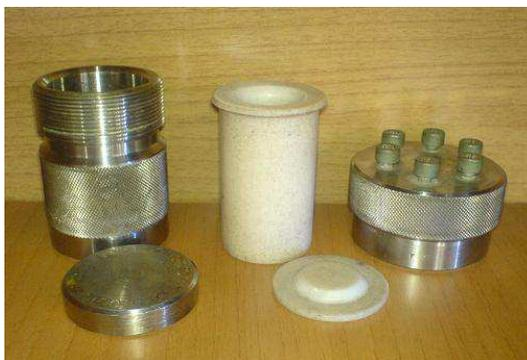
**Figure I-5** : autoclave utilisé au laboratoire pour les synthèses hydrothermales.
