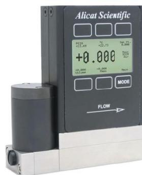
**Figure III-29 :** Débitmètre de type « Alicat » utilisé dans l'expérience pour le contrôle des gaz.
