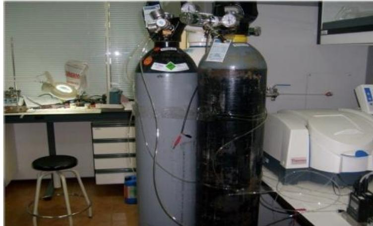
**Figure III-28 :** Les bouteilles d'oxygène et d'oxyde de carbone
