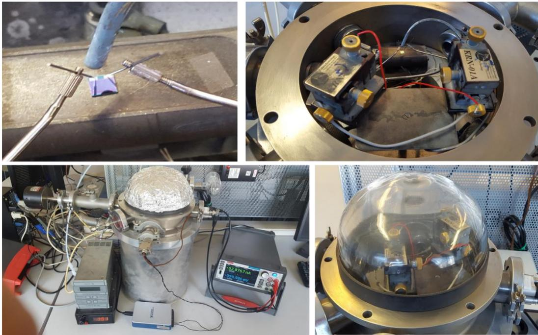
**Figure 5.6** Schéma du Banc de mesures sous air sec – sous vide
