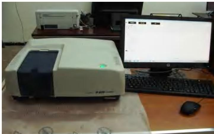
**Figure V.8** Spectrophotomètre UV-Visible de type JASCO V-630.
