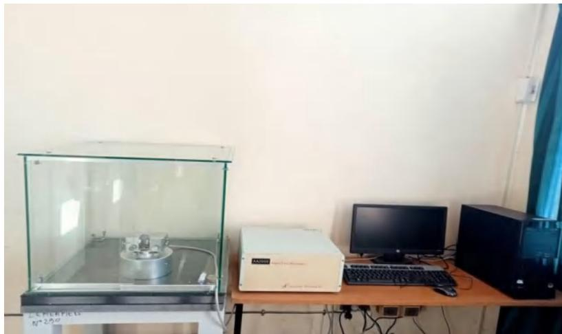
**Figure V.7.** Microscope de force atomique utilisé.
