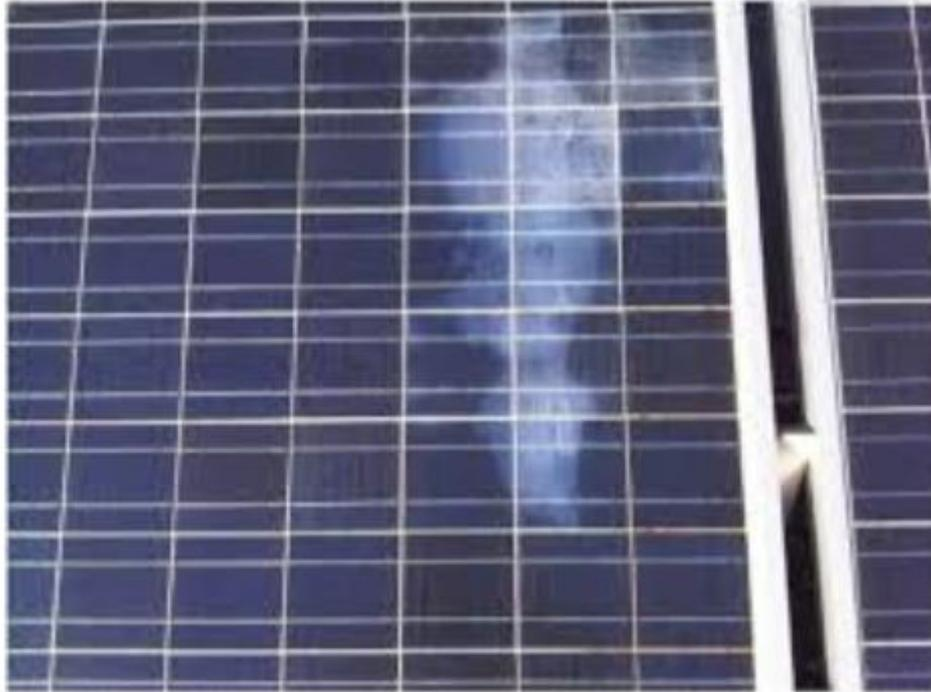
**Figure.27. L'effet de la délamination**
