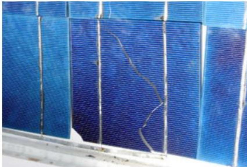
**Figure.24. fissure de la cellule solaire**
