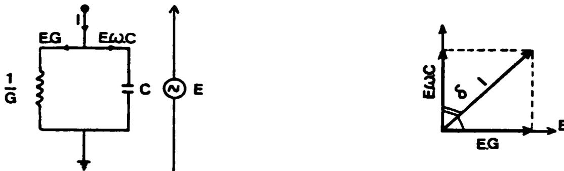
FIGURE II.19. : Schéma équivalent d'un échantillon de diélectrique, circuit parallèle.
