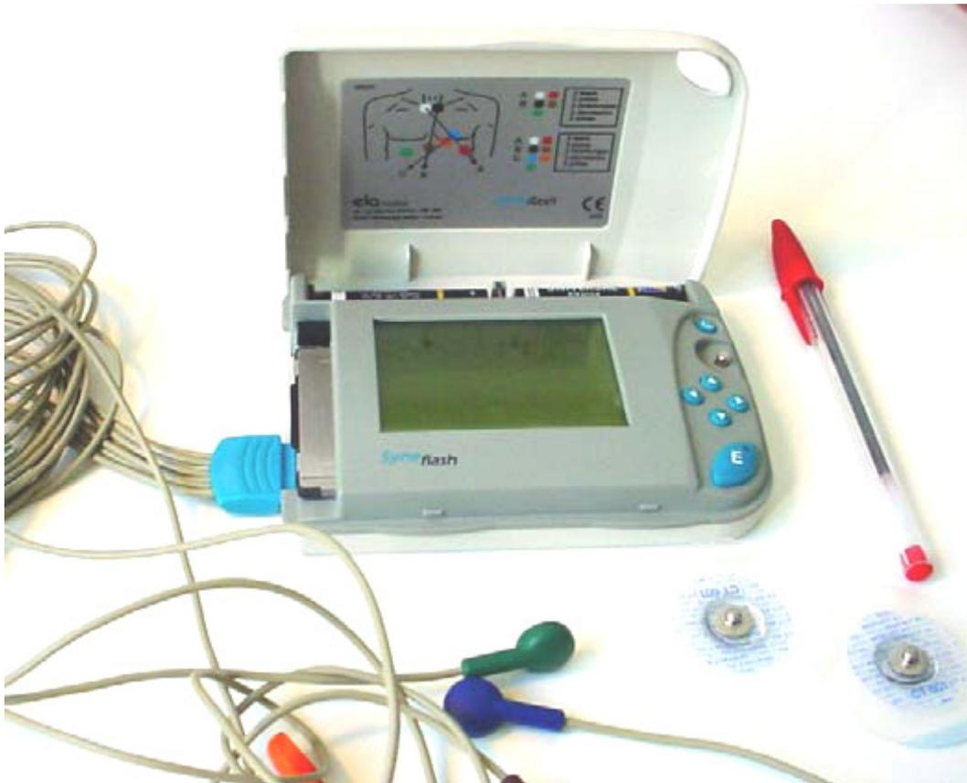
FIG. I.16- Enregistreur Syneflash de la société Ela Medical. Le signal cardiaque enregistré pendant 24 heures est stocké sous forme numérique à 200Hz sur une carte à puce du type SanDisk. Cette carte est ensuite directement lisible sur un ordinateur PC et l'enregistrement peut être analysé avec le logiciel Synetec produit par la même société.
