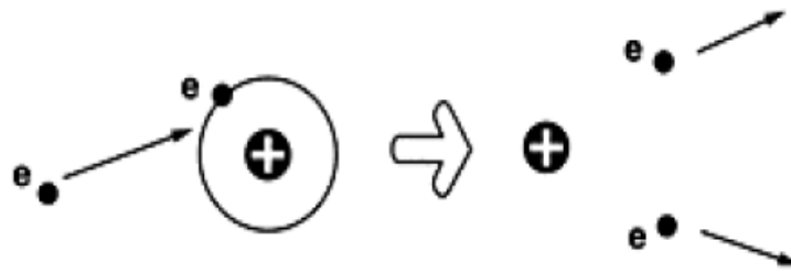
Figure II. 4 : Processus d'ionisation d'un atome [4]
