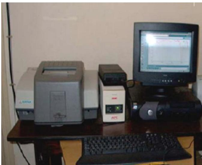
Figure I-6 : spectrophotomètre FTIR de type Thermo Nicolet Avatar 360
