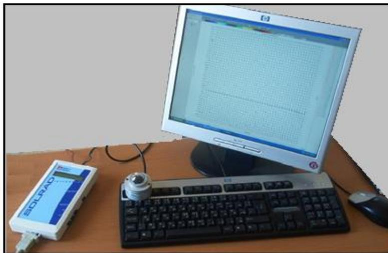
**Fig. (V.9) :** mesure de l'enseillement par l'utilisation d'un Pyranometre, Intégrateur et un Ordinateur
