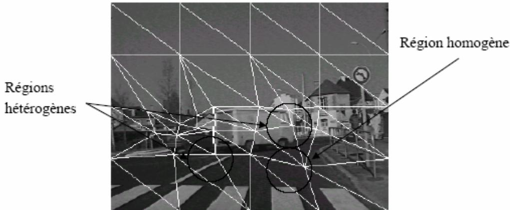
Figure 2.11: maillage déformé uniquement par prise en compte d'un critère de mouvement
