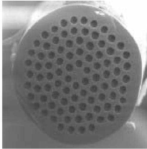
Figure II-23 : Exemple de fibre à cristal photonique.
