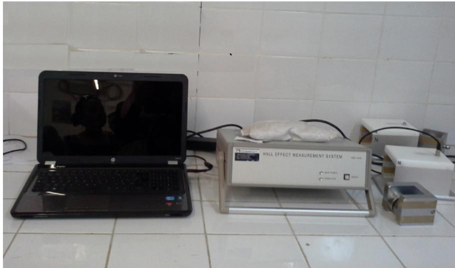
Fig. II.28 – Photographie du montage expérimentale d'une mesure par effet Hall
