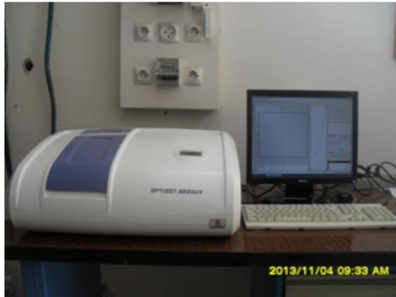
Fig. II.23 – Photographique du spectrophotomètre UV-Visible : "OPTIZEN 220 UV"
