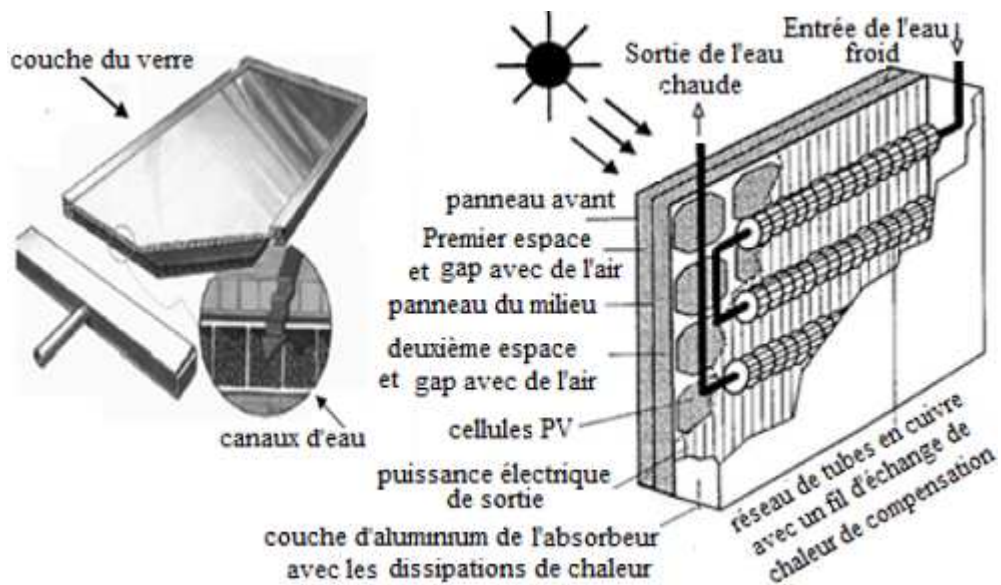
Fig.2.6. Coupe transversale de capteur PVT en polymère carré (PPO) [62, 63]
