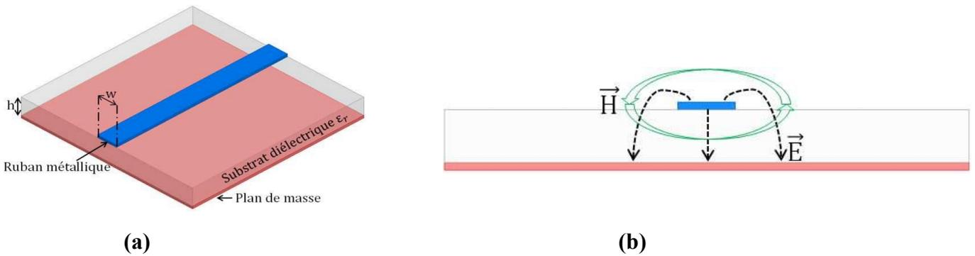
**Figure 1.1: (a) Vue d'une ligne micro-ruban, (b) Représentation des lignes de champs électrique et magnétique**
