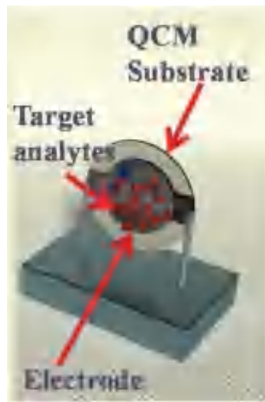
Figure I-8 : Capteur à onde acoustique de volume QCM
