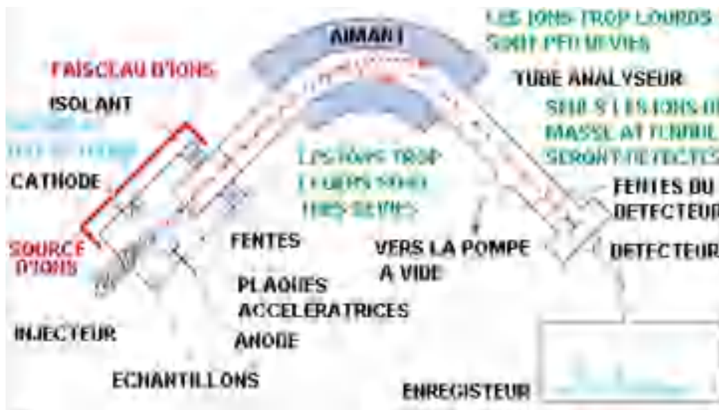
Figure I-3 : Schéma de la structure d'un spectromètre de masse
