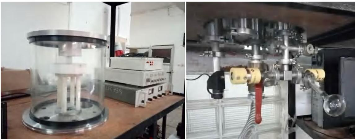
*Figure III.1: Photo de l'enceinte à vide en verre borosilicate de géométrie cylindrique avec le joint en L en Viton*
