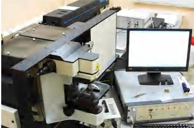
*Figure II.22: Spectromètre Raman HR 800 utilisé pour analyser les nanoparticules déposées par microtorche plasma créé dans le mélange  $CH_4/H_2$*
