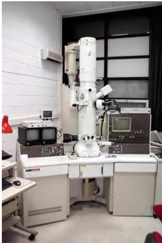
*Figure II.17: La microscopie électronique à transmission (TEM) (JEOL 200 KV JEM 2011) a été utilisée pour observer la morphologie des nanoparticules de carbone*
