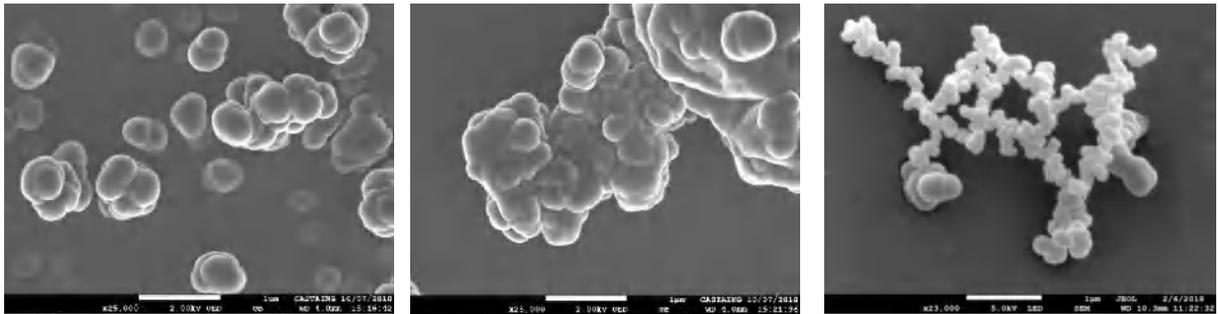
Figure III.22: Photo montrant la phase de formation de divers clusters par plasma à partir de vapeurs de vapeurs de HMDSO. Condition de dépôt : Puissance 19 W, pression 0.4 mbar)
