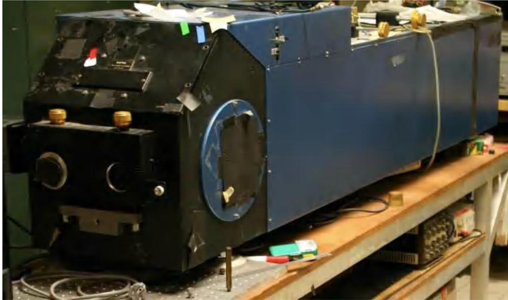
Figure II.10: spectromètre haute résolution de marque SOPRA
