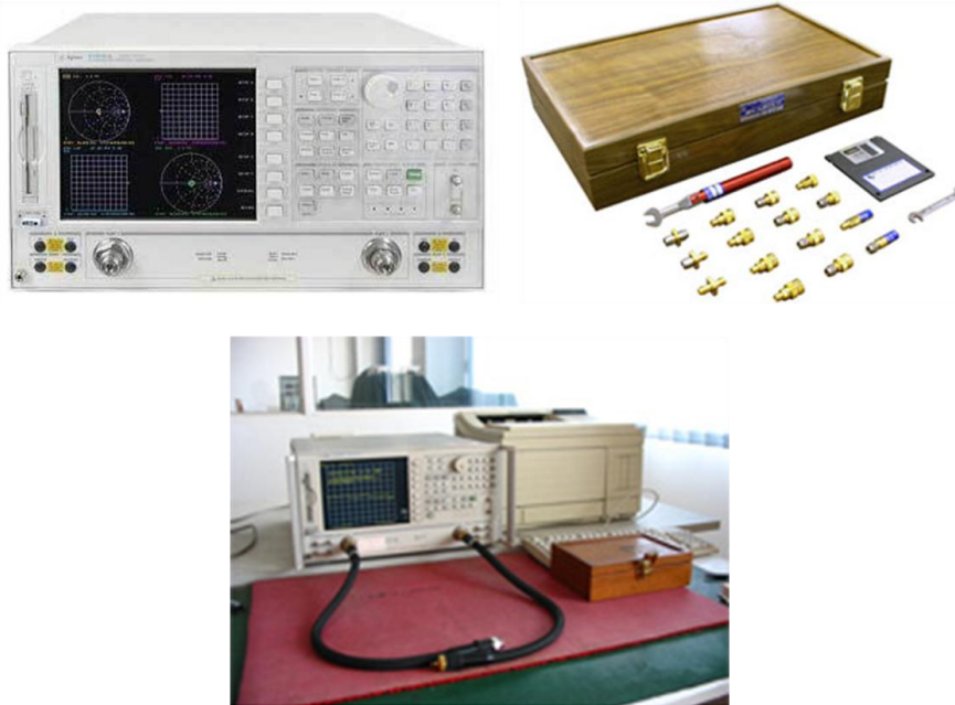
Figure III. 21. Photographie de l'analyseur de réseaux Agilent 8722ES et le kit de calibrage.
