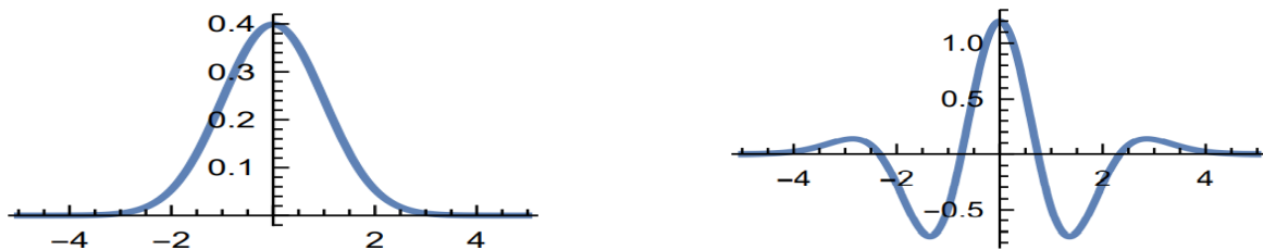
Figure I. 5. Impulsion gaussienne et sa dérivée (formes d'onde dans le domaine temporel).
