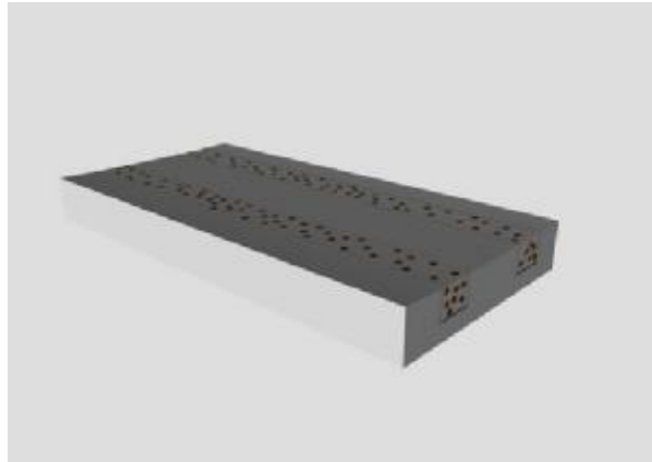
Figure 67 : Schéma du matériau composite formé de verre dopé de NP d'argent et le verre
