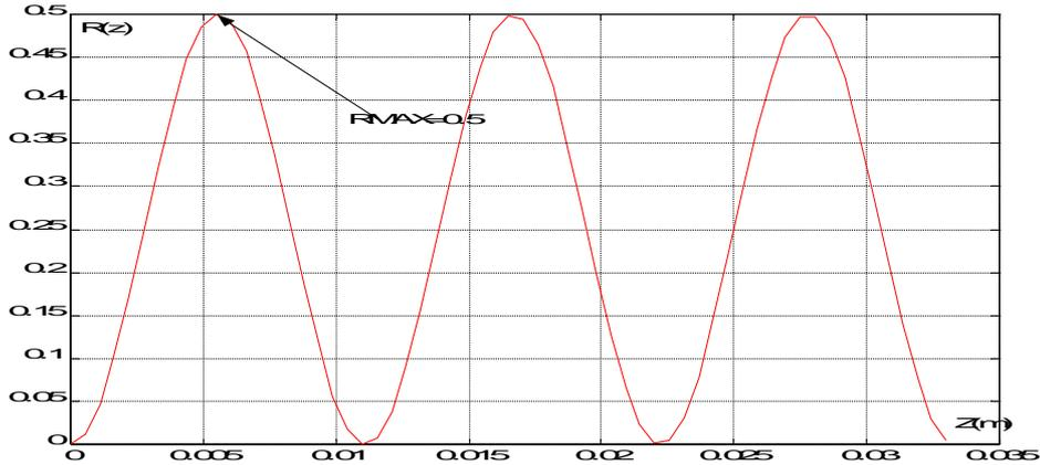
**Fig. I.6** - Evolution du rendement de conversion  $R(z)$  en fonction de la longueur de propagation  $z$  en cm. Les caractéristiques du guide sont  $\Delta\beta=400^\circ/\text{cm}$  et  $\theta_F=200^\circ/\text{cm}$
