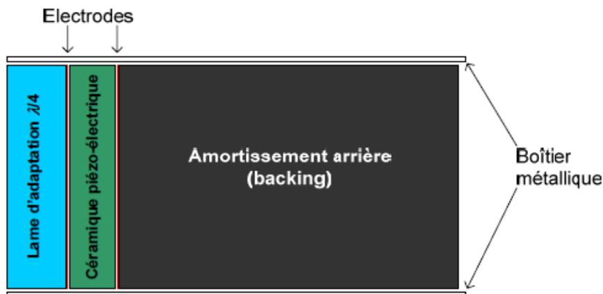
Figure III.1 : Schéma de fonctionnement d'un transducteur.
