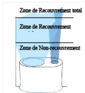
Fig III.8 —Représentation schématique de la zone de recouvrement
