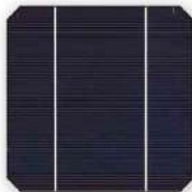
**Figure II.6.** Cellule en Silicium monocristallin
