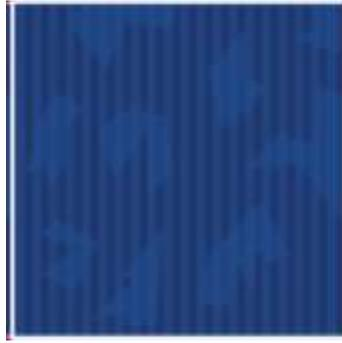
**Figure II.7.** Cellules de silicium poly cristallin
