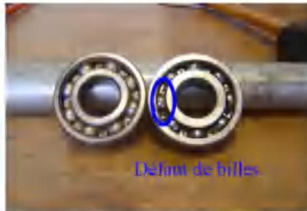
Figure 114. Vue des roulements sains et défectueux (billes écorchées) [1].
