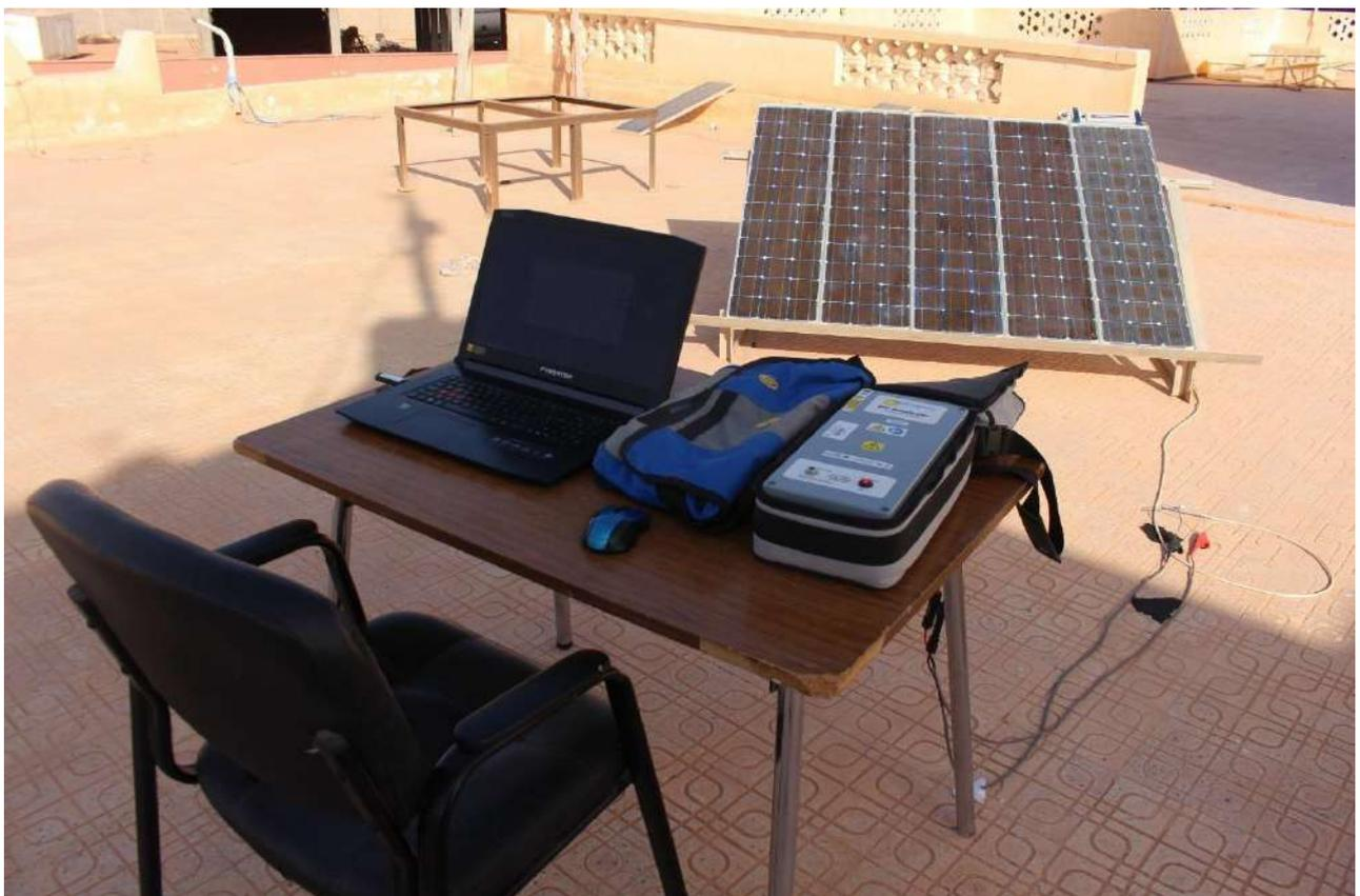
**Figure IV.6** Banque de caractérisation des modules photovoltaïques testés.
