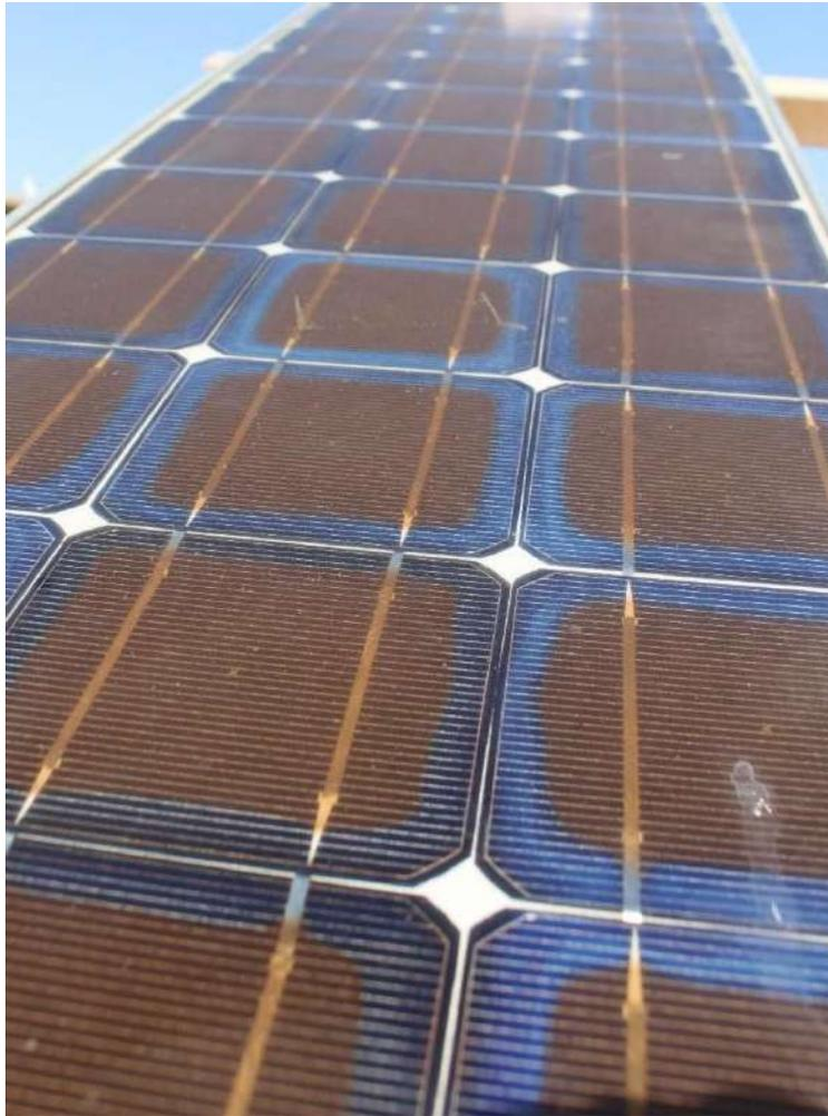
**Figure III.15** Changement de couleurs des cellules solaires PV.
