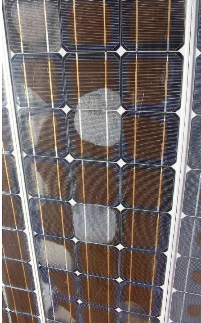
**Figure III.20** Boules d'aire (Bubbles).
