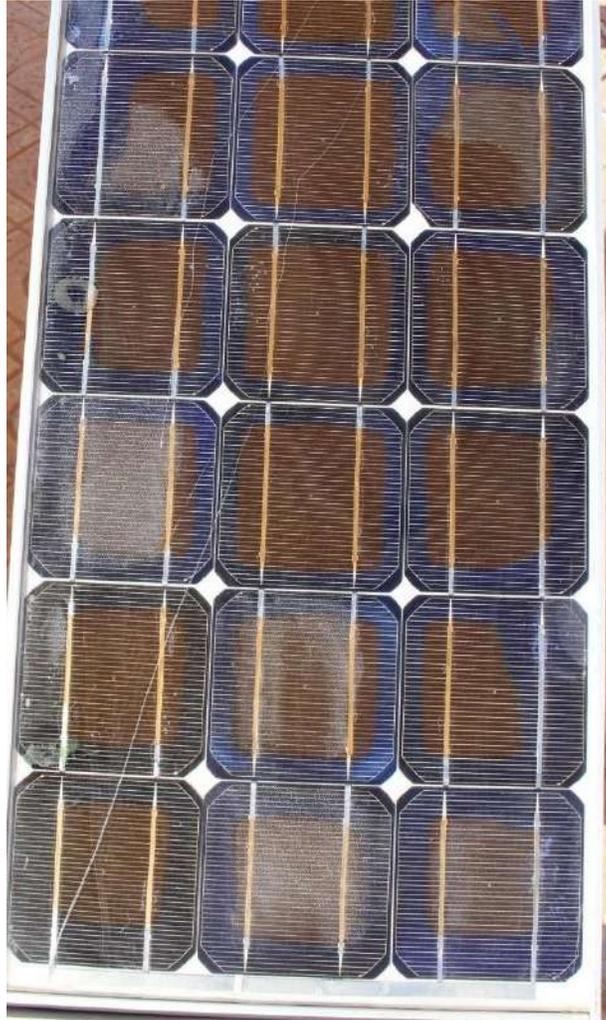
**Figure III.17** Corrosion des interconnexions.
