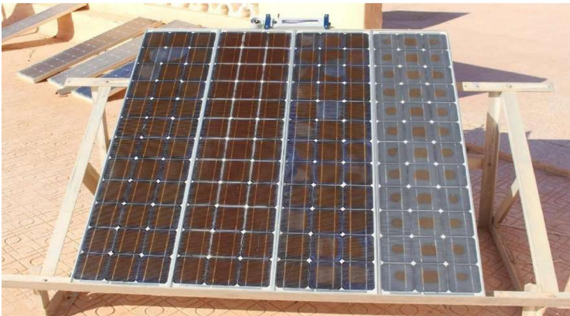
**Figure IV.7** Panneaux monocristallin testés UDTS 50.
