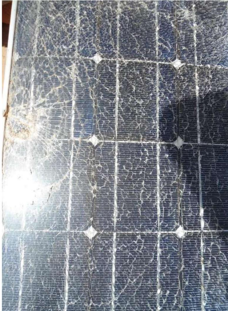
**Figure III.19** Fissures et bris des modules photovoltaïques.
