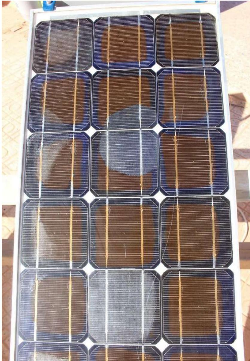
**Figure III.16** Délamination des cellules solaire PV.
