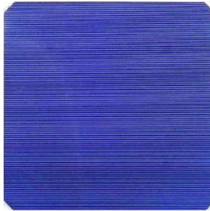
**Figure II.9** Cellule à Hétérojonction (HIT).
