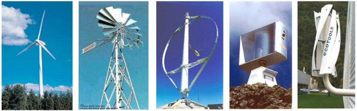
a) Eoliennes à axe horizontal b) Eoliennes à axe vertical
