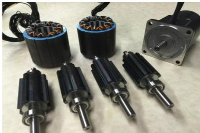
Figure 1.3 Machine à reluctance variable [5]
