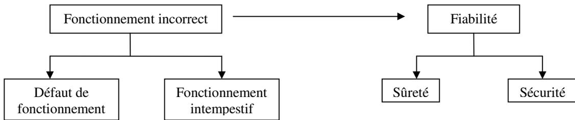
Fig. II.3 - Fiabilité d'une protection.
