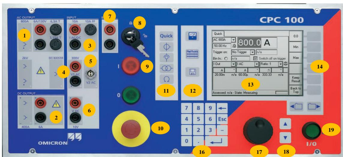
Fig.V.5 - Vue avant de la caisse d'injection Omicron [36].
