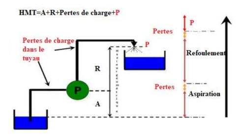
Figure 1.12. Schéma de calcule HMT[29].
