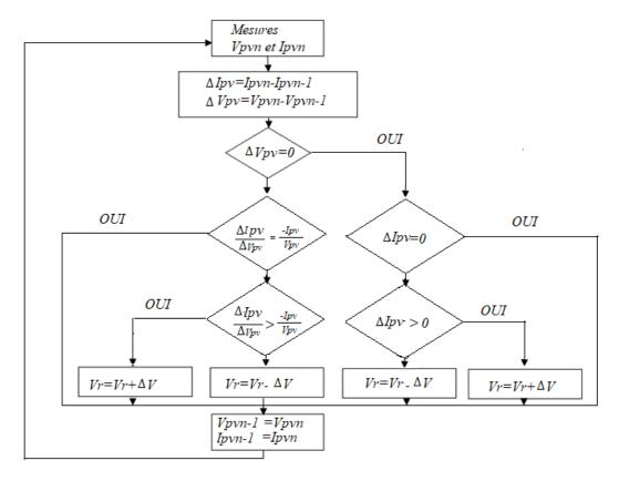
Figure 4.10 Algorithme de la méthode Incrément de conductance.
