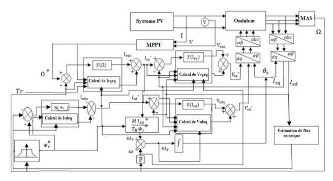
Figure 3.15. Schéma bloc global de la commande par mode glissant de la MAS.
