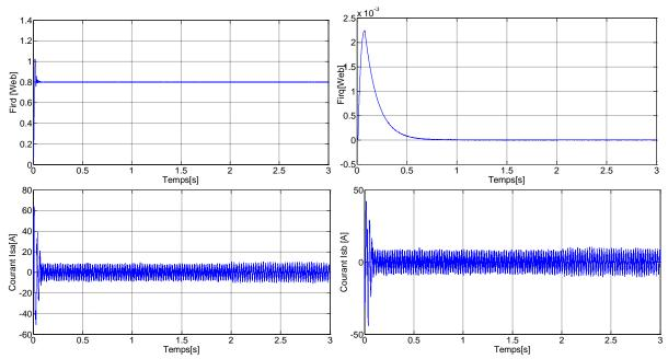
Figure 3.16. Les caractéristiques de la MAS avec la régulation en cascade de la vitesse et du flux rotorique par mode glissant.
