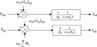
Figure 3.4. Termes de couplages dans les équations statoriques
