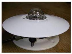
Figure 1.5. Le pyranomètre [19].
