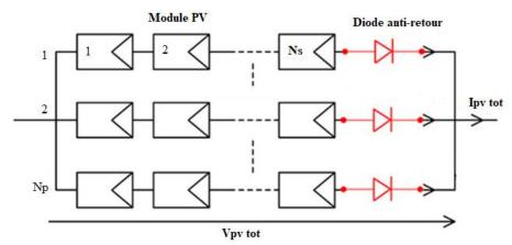
Figure 1.8. Association d'un champ PV ( $N_s$  modules en séries et  $N_p$  branches en parallèles) avec la diode de protection anti-retour.
