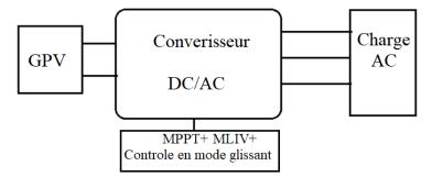
Figure 4.3Couplage avec optimisation d'un système de pompage photovoltaïque.
