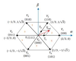
Figure 2.14 La relation entre  $\overline{V}_{ref}$  et les secteurs de tension.
