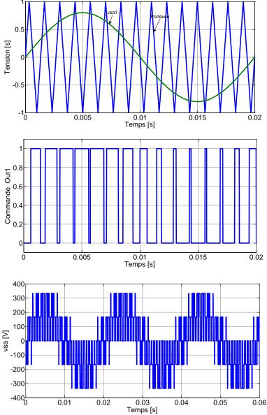
Figure 2.12 Signaux d'une phase pour MLIS
