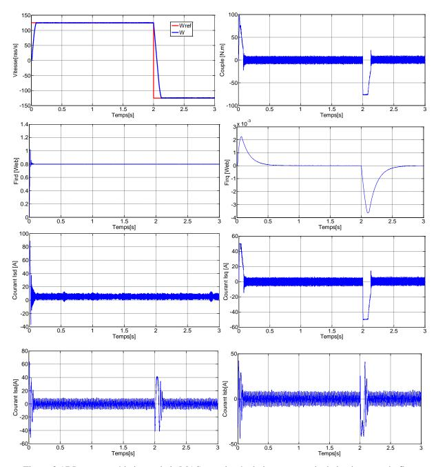
Figure 3.17.Les caractéristiques de la MAS avec la régulation en cascade de la vitesse et du flux rotorique par mode glissant avec une inversion du sens de rotation.
