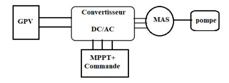
Figure 2.1. Conception globale de la structure de pompage photovoltaïque
