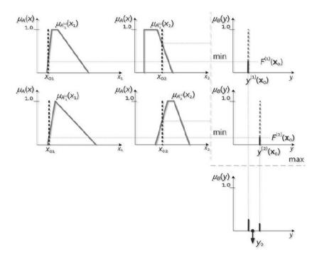
La figure C.4. Un exemple de raisonnement approximatif avec le système flou Takagi- Sugeno-Kang avec deux entrées et deux règles floues si-alors
