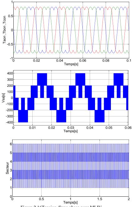
Figure 2.16Tension d'une phase pour MLIV
