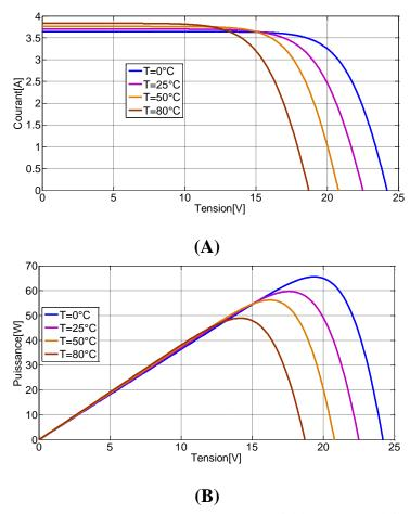
Figure 2.8. Courbes (I-V) et (P-V) pour une température variable et un ensoleillement de *IKW/m*<sup>2</sup>
