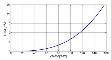
Figure 2.19La simulation de La courbe caractéristique de la pompe (Débit – Vitesse)
