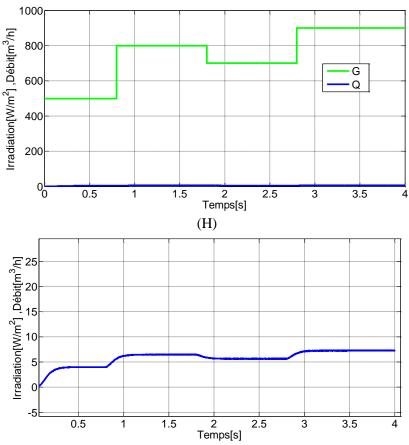
Figure 4.21Performances du système de pompage PV avec rayonnement variable, ou la technique d'optimisation utilisée est MPPT (INC-COND).
