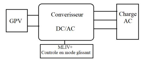
Figure 4.1Couplage direct d'un système de pompage photovoltaïque.
