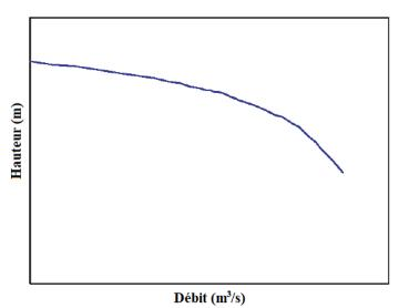
Figure 1.13. La courbe caractéristique de la pompe (Débit – hauteur) [31].
