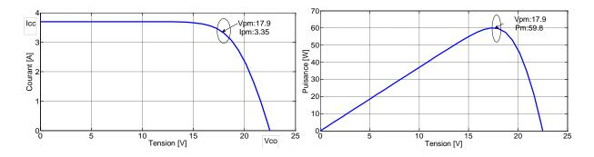
Figure 2.5 Caractéristique I(V) & P(V) du panneau TE500
