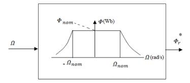
Figure 3.8.Bloc de fluxage.
