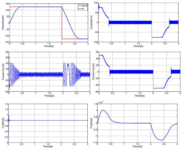
Figure 3.18. Comportement de la MAS vis-a-vis l'augmentation du moment d'inertie (J = 5Jn a t=2s)
