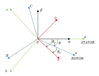
Figure 2.17 Les trois Référentiels : triphasé (a,b,c)- fixe  $(\alpha,\beta)$ -tournant (d,q)
