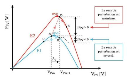
Figure 4.6 Divergence de la commande P&O lors de variations d'irradiation.
