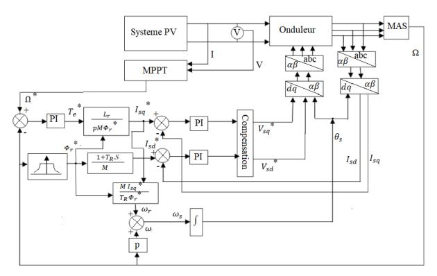
Figure 3.3. Le schéma bloc de la commande IFOC de moteur asynchrone
