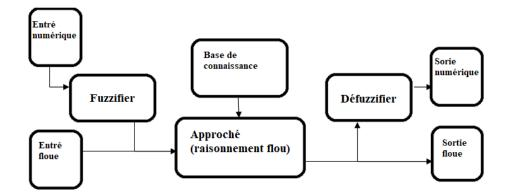
Figure C.1. La structure typique d'un système flou
