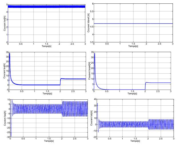
Figure 3.9. Les caractéristiques de la MAS commandé par IFOC dans le cas où l'onduleur est commandé par MLIV.
