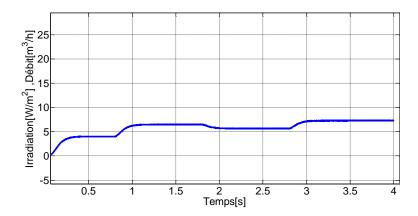
Figure 4.23Performances du système de pompage PV avec rayonnement variable, ou la technique d'optimisation utilisée est MPPT floue.
