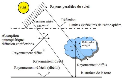
Figure 1.3. Radiation solaire global total-Direct et Diffuse
