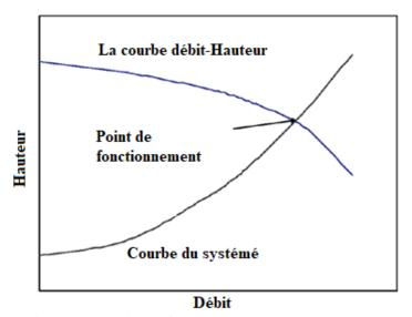
Figure 1.14. Point de fonctionnement de la pompe [31].
