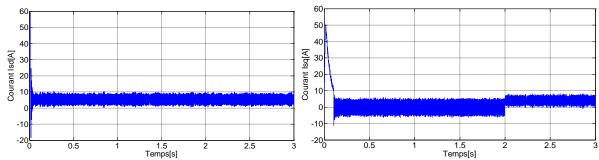
Figure 3.19. Comportement de la MAS vis-à-vis l'augmentation de la résistance rotorique (Rr = 2Rrn a t=2s)
