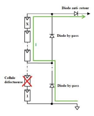
Figure 1.9. Association d'un X cellules en séries avec la diode de protection (by-pass)
