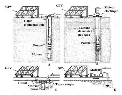
Figure 1.16. Exemples d'installations de pompes solaires
