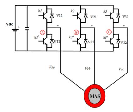
Figure 2.11Onduleur à IGBT triphasé fournissant la puissance à une machine asynchrone
