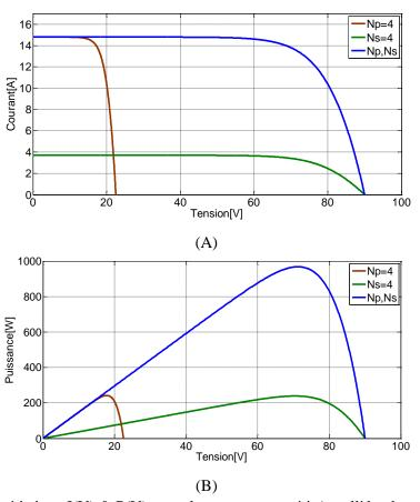
Figure 2.6. Caractéristique I(V) & P(V) pour le groupement série/parallèle des panneauxa température et éclairement fixes :  $G = 1 \, kW/m^2$ et  $T = 25 \, ^{\circ}C$
