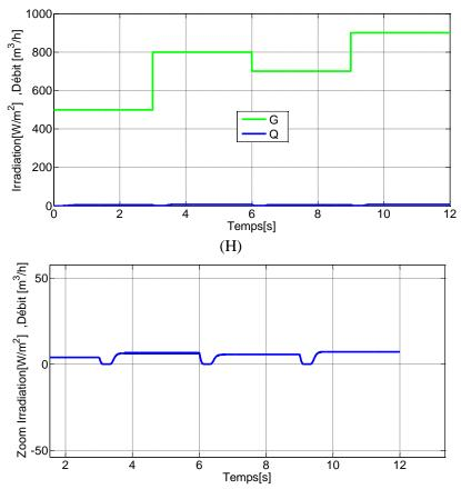
Figure 4.22Performances du système de pompage PV avec rayonnement variable, ou la technique d'optimisation utilisée est MPPT basée sur des relations de proportionnalité (fraction de*Vco*)
