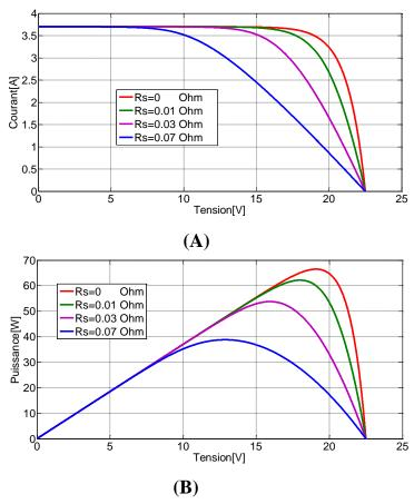
Figure 2.9Influence de la résistance série sur la caractéristique I(V) & P(V)
