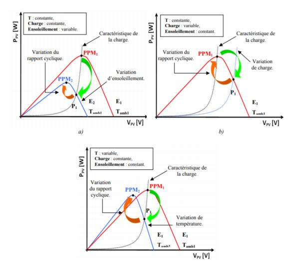
Figure 4.2: Recherche et recouvrement du point de puissance Maximal
