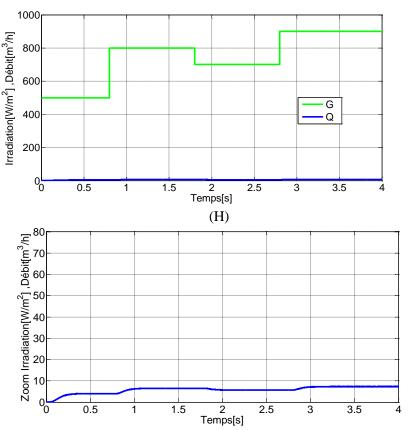
Figure 4.19Performances du système de pompage PV avec rayonnement variable, ou la technique d'optimisation utilisée est MPPT (P&O).
