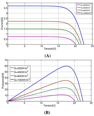
Figure 2.7. Courbes (I-V) et (P-V)pour un ensoleillement variable et une température de 25°C
