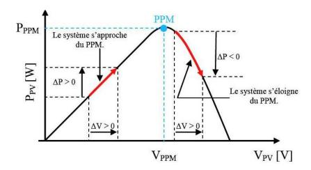
Figure 4.4La commande MPPT (P&O) sur la caractéristique P<sub>PV</sub> (V<sub>PV</sub>)d'un panneau photovoltaïque.
