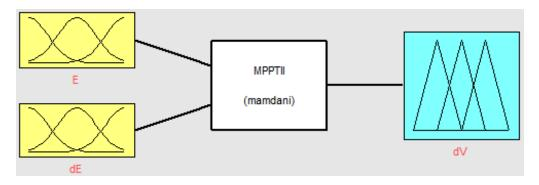
Figure 4.15Schéma de fonctionnement d'un contrôleur flou
