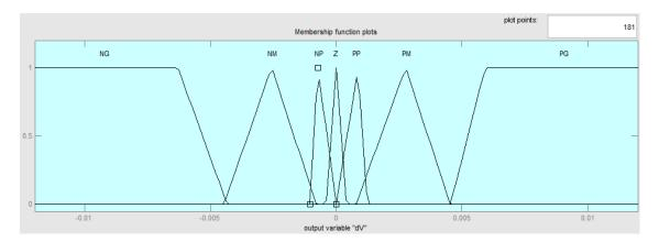
Figure 4.14Les fonctions d'appartenances de la sortie (la perturbation)
