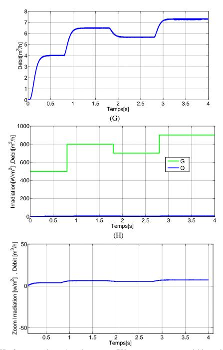
Figure 4.20Performances du système de pompage PV avec rayonnement variable, ou la technique d'optimisation utilisée est MPPT (Hill Climbing).
