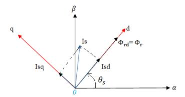
Figure 3.1. Orientation du flux rotorique
