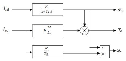
Figure 3.2. Modèle courant
