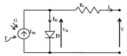
Figure 2.3 Modèle électrique équivalent simplifié de la cellule photovoltaïque.
