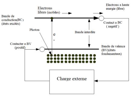
Figure 1.7. Schéma d'une cellule solaire [22].
