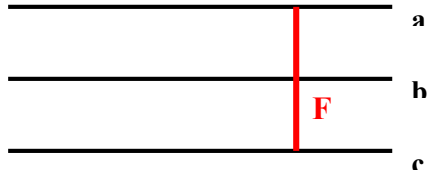
Figure 5 - Défaut entre trois lignes
