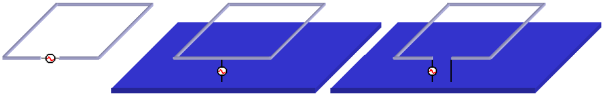
Figure I.1 Antenne filaire de forme boucle résonante.
