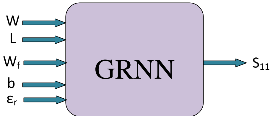
Figure IV.14 structure du réseau GRNN.
