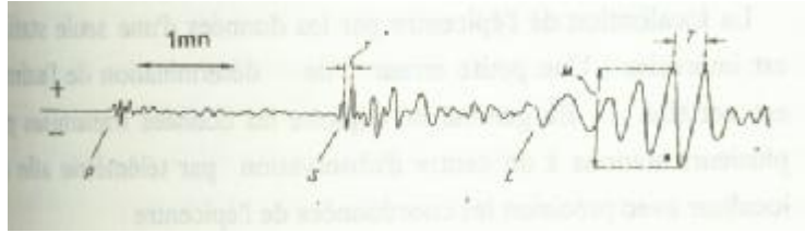
Fig. 1.13 Seismogramme typique d'un séisme lointain. P, S, L : arrivées des ondes P, S et L respectivement ; M maximum des ondes de surface.
