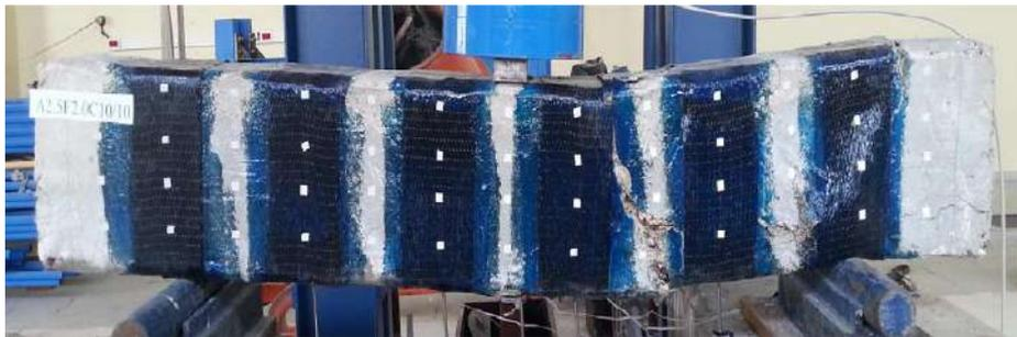
Figure 4.37. Fissures sur la poutre A2.5F2.0C10/10(expérimentation).
