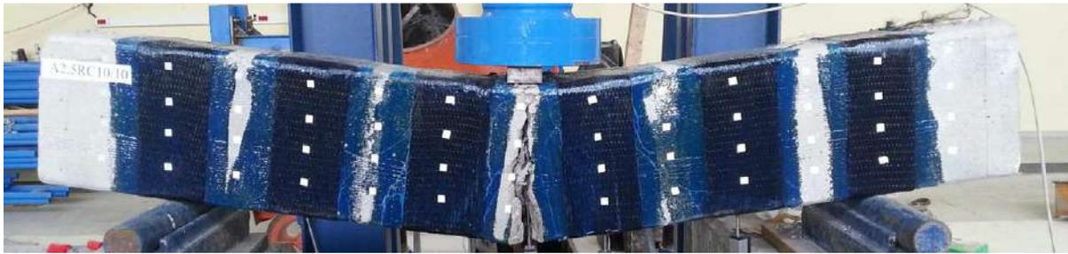
Figure 4.35. Fissures sur la poutre A2.5RC10/10.(expérimentation).
