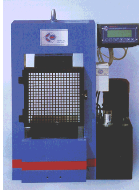
Figure 3.17. Machine utilisée dans les essais de compression sur éprouvettes cylindriques 16 × 32 cm
