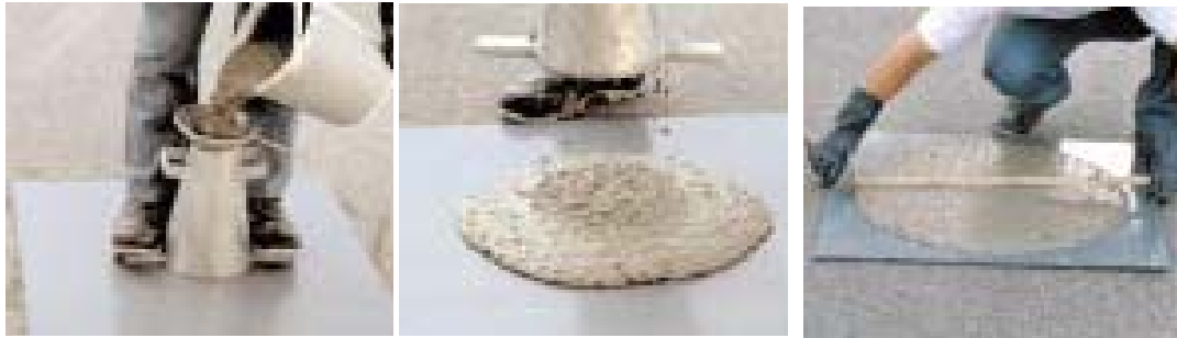
Figure 3.11. Détermination de l'étalement (Slump Flow)
