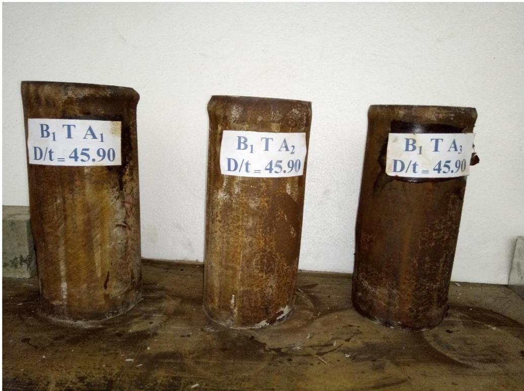
**Photo 4. 5:** mode de rupture des TARB de formulation B<sub>1</sub>
