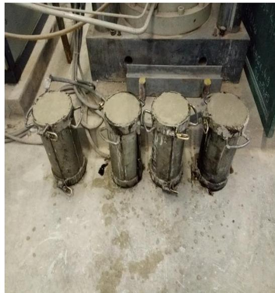
**Photo 4. 3:** Préparation des éprouvettes.
