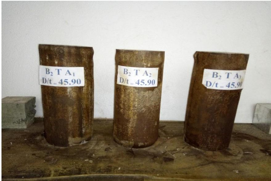
**Photo 4. 6:** Mode de rupture des TARB de formulation B<sub>2</sub>.
