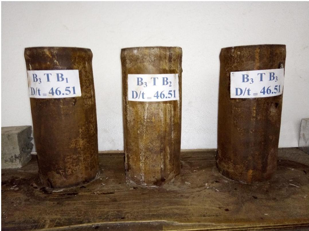
**Photo 4. 7:** Les spécimens de formulation B3 après l'essai d'écrasement.
