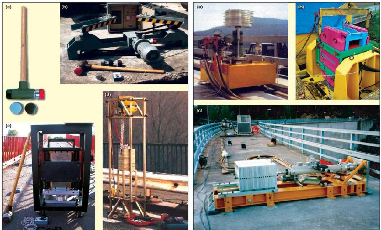
**Figure 1:** (a) Marteau d'impulsion; (b) Vibreur à masses excentriques; (c) Excitateur électrodynamique; d) Dispositif d'excitation d'impulsion pour les ponts (Cunha et Caetano, 2006). **Figure 2:** Agitateurs servo-hydraulique pour exciter: (a) Ponts verticalement (b) Agitateur électro-hydraulique et (c) Barrages latéralement (Cunha et Caetano, 2006).
