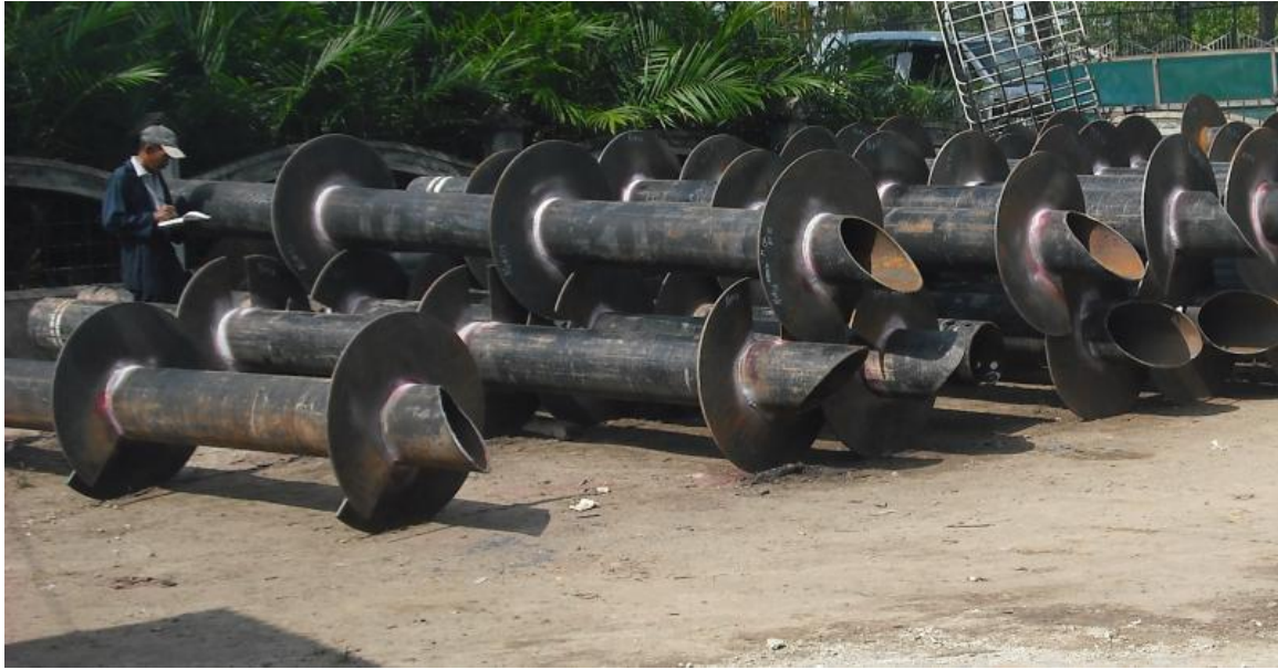
Figure 1-7. Photo des pieux hélicoïdaux (Cyntech - A Keller Company)
