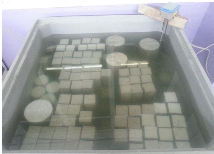
*Figure IV.10 : Bassin de conservation des éprouvettes.*
