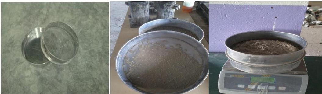
Figure IV.15: Essai de stabilité au tamis
