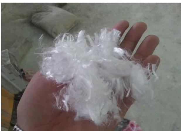
*Figure. IV.5 : fibre de polypropylène.*
