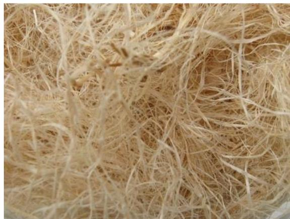
*Figure II.10: Fibre de chanvre*
