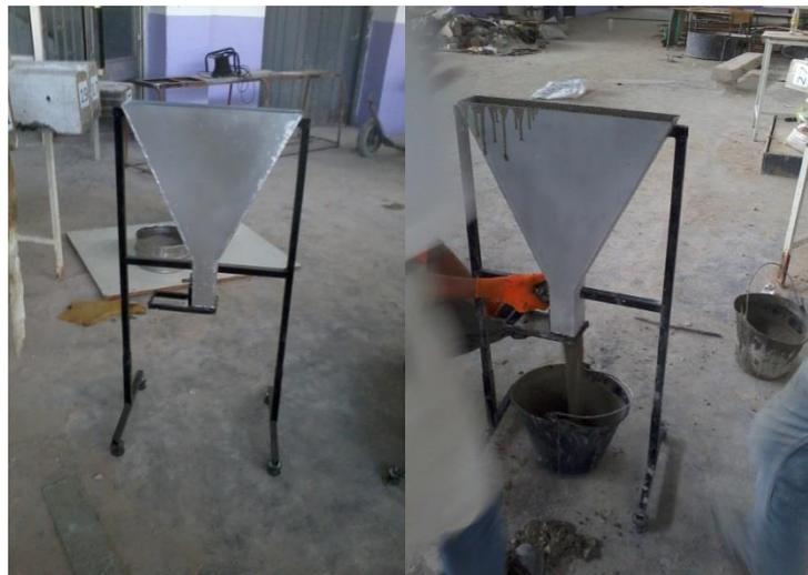
*Figure IV.13 : L'essai de V-funnel*
