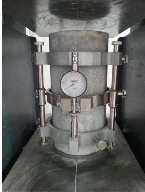
*Figure IV.20: Appareil du module d'élasticité.*
