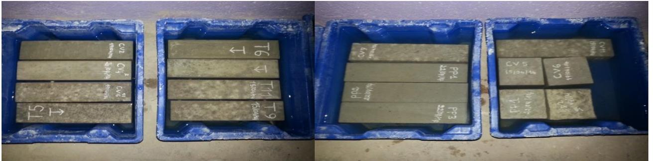
Figure IV.26 : les bacs de conservation (solution ( $\text{Na}_2\text{SO}_4$ ))
