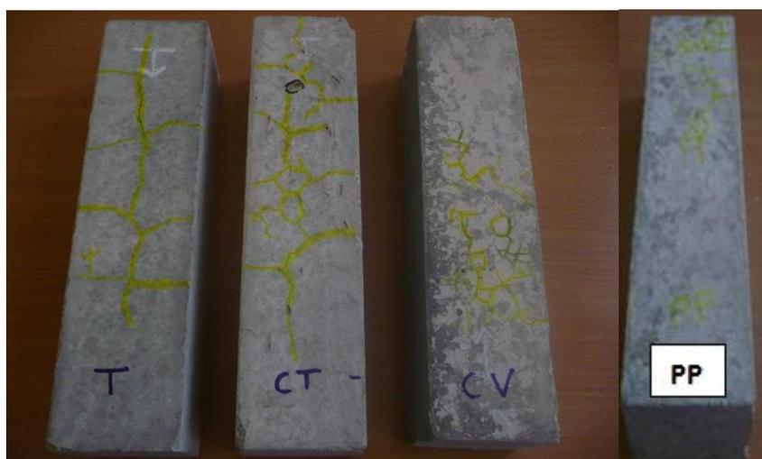
Figure V.29: les fissures multidirectionnelles après cinq cycles pour les quatre mélanges
