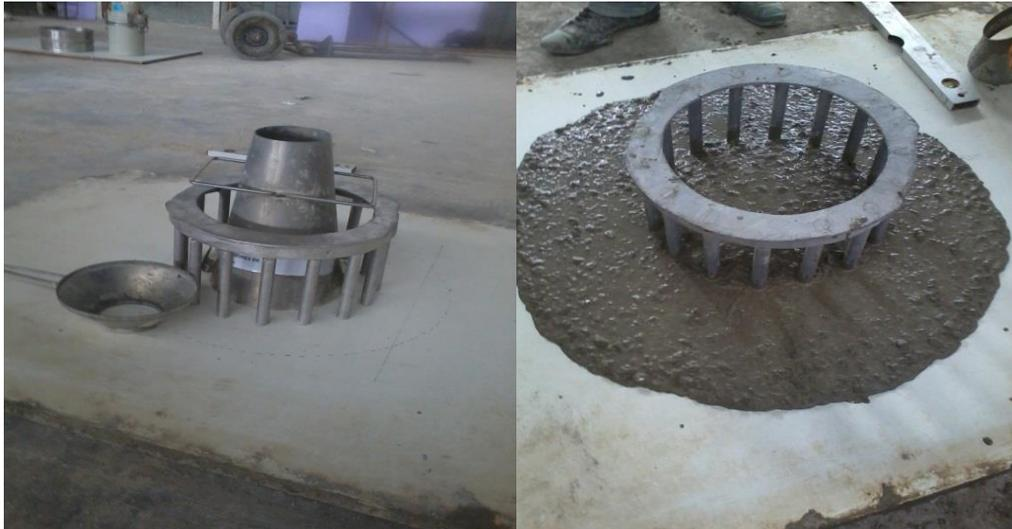
Figure IV.14 : L'essai de J-Ring.
