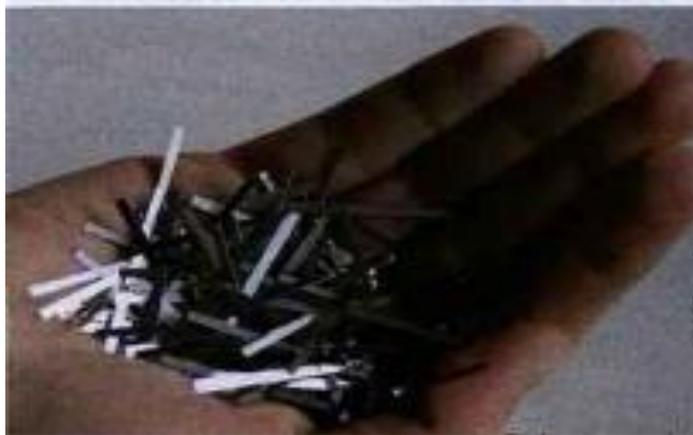
*Figure II.2 : Fibre de fonte amorphe*
