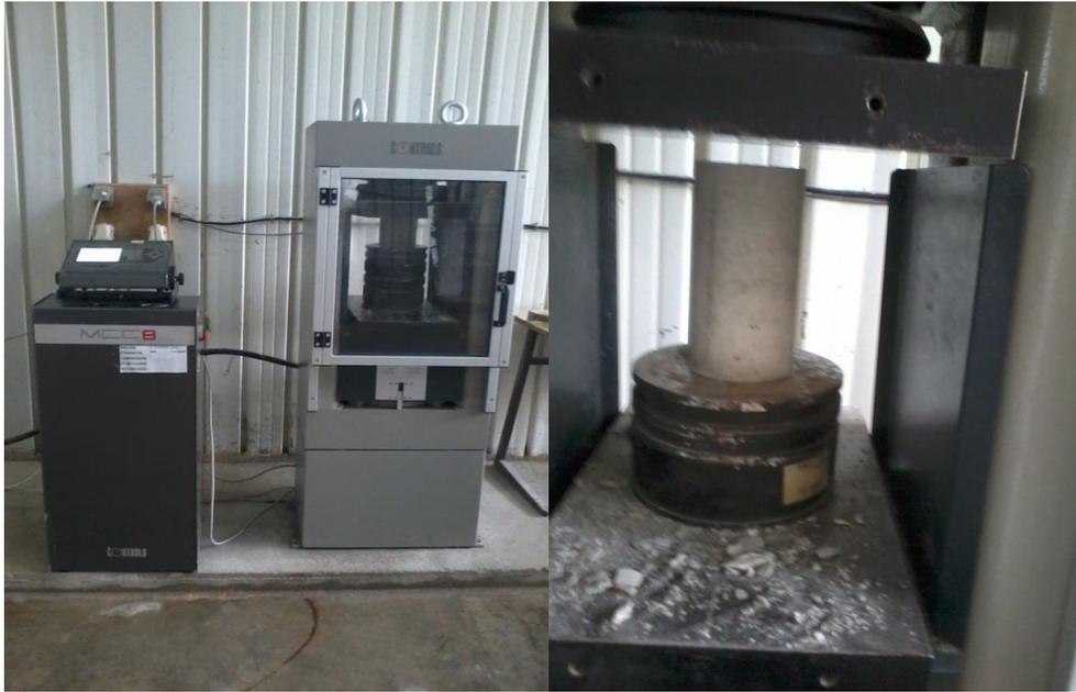
*FigureIV.18 : Appareil d'essai de compression*
