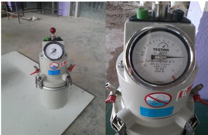
Figure IV.16: Dispositif de mesure de l'air occlus
