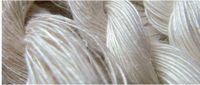
*Figure II.7: Fibre de lin*
