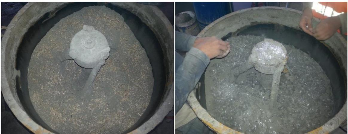
*Figure IV.8 : Répartition des fibres à sec*
