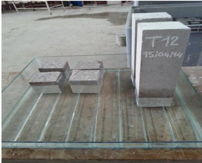
Figure IV.25 : Essais d'absorption capillaire
