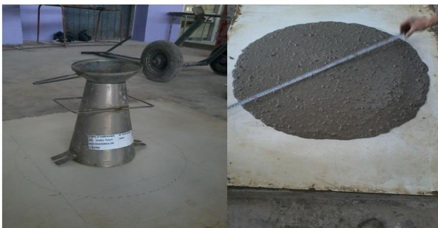
Figure IV.11: Principe de l'essai au cône d'Abrams
