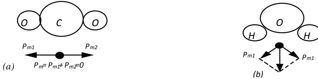
Figure II.2. Polarisation dipolaire ou d'orientation
