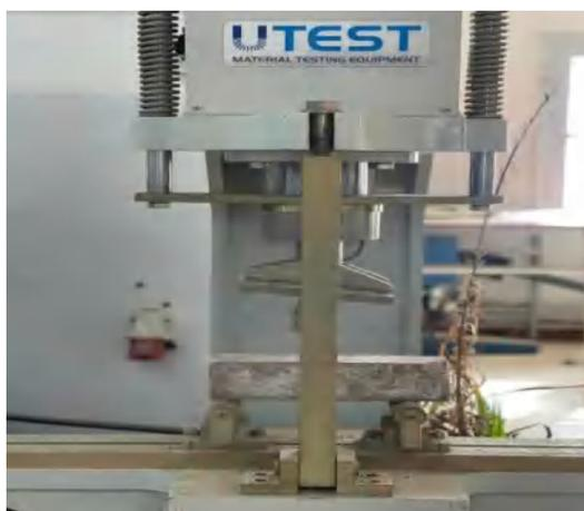
**Figure IV.21** : Mesure de la résistance à la traction par flexion.
