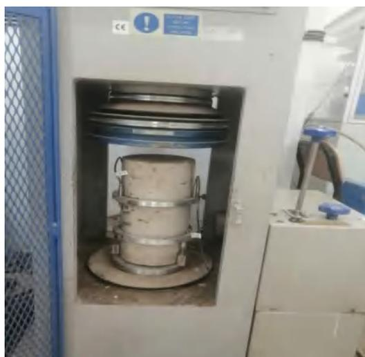
**Figure IV.22** : Mesure du module d'élasticité.
