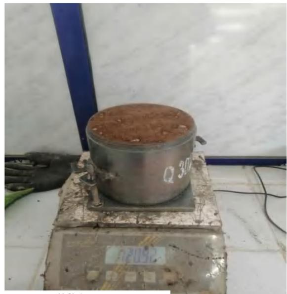
**Figure IV.19** : Essai Proctor modifié.
