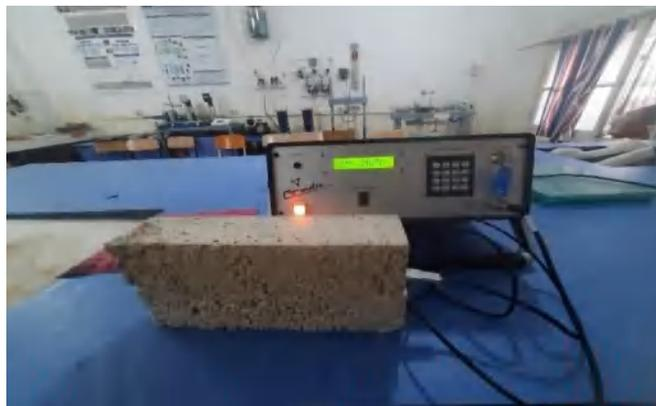
**Figure IV.27** : Essai de conductivité thermique par CT mètre.
