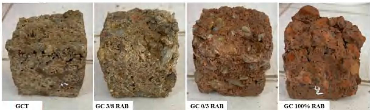
**Figure V.13 :** Aspect des éprouvettes après 300 cycles de gel/dégel des différents GC à base de granulats de RAB.
