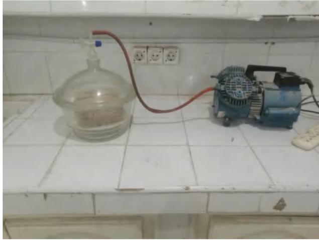
**Figure IV.25** : Essai de porosité.
