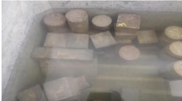
**Figure IV.26** : Absorption d'eau par immersion.
