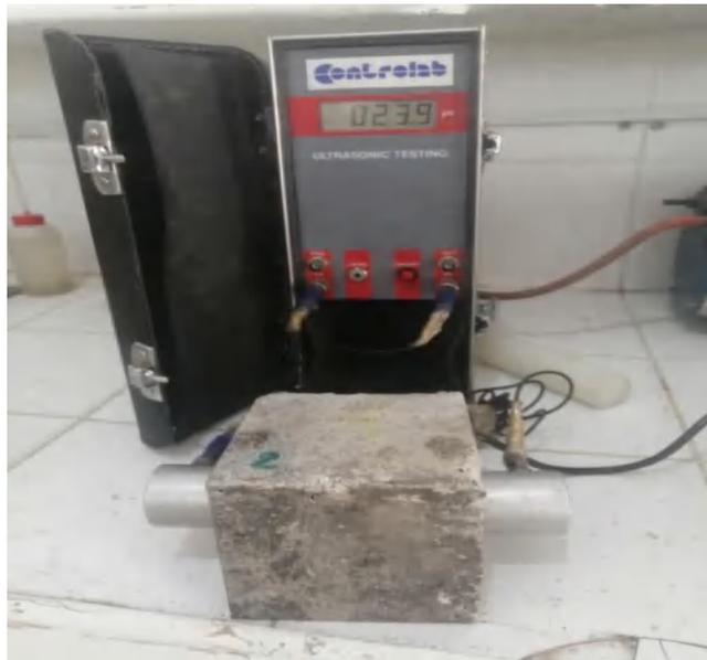
**Figure IV.24** : Appareil de mesure de la vitesse d'auscultation sonique.
