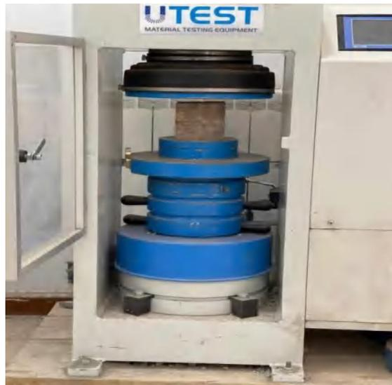
**Figure IV.20** : Mesure de la résistance à la compression.
