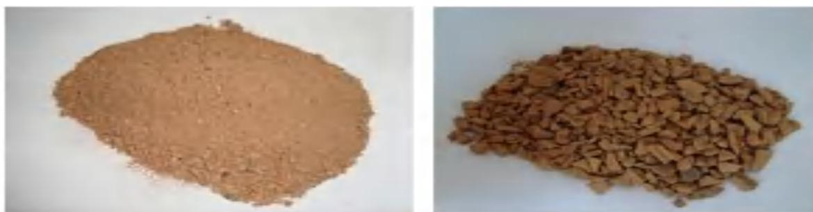
**Figure II.1:** Brique recyclée sous forme de granulats fins et grossiers.
