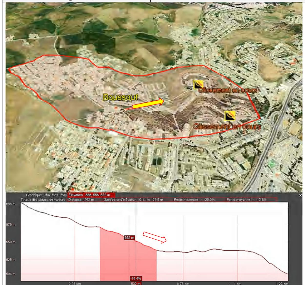
Figure 2.12. Profil donnant la pente d'un des talus de la zone de la cité Boussouf avec une vue d'ensemble du site.
