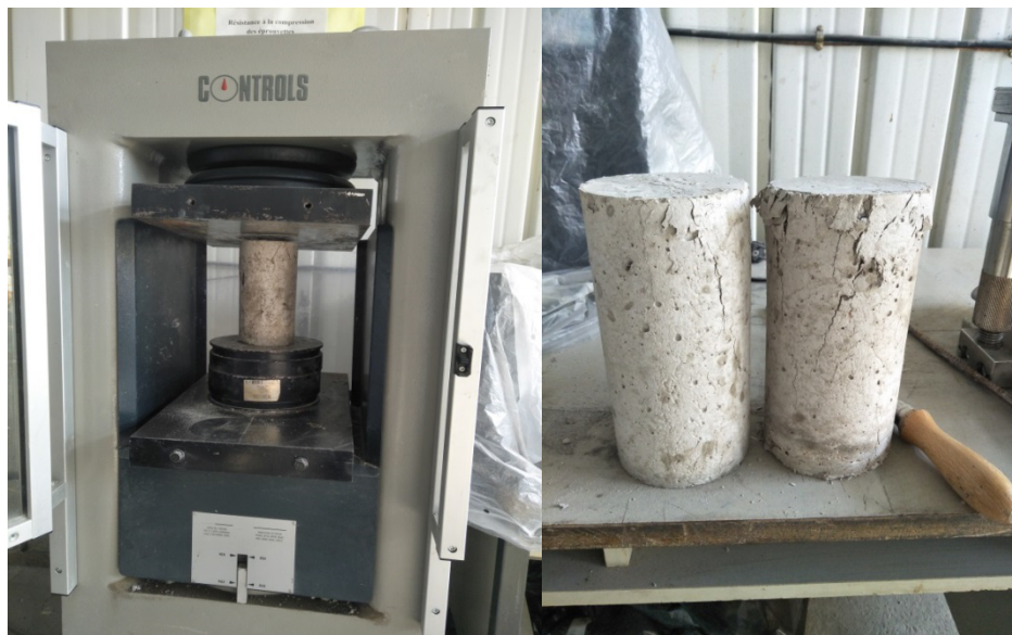
Figure III.3 Essais à la compression simple réalisés sur un béton HC-0.25
