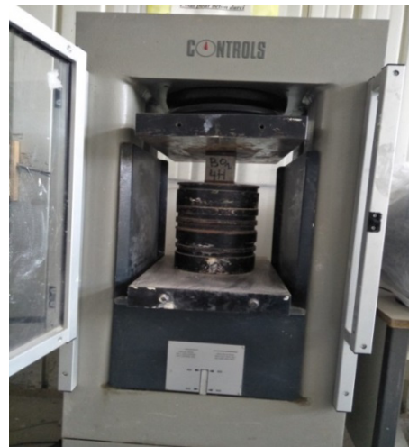
Figure IV.7 Essais de compression simple des échantillons 7x7x7 cm
