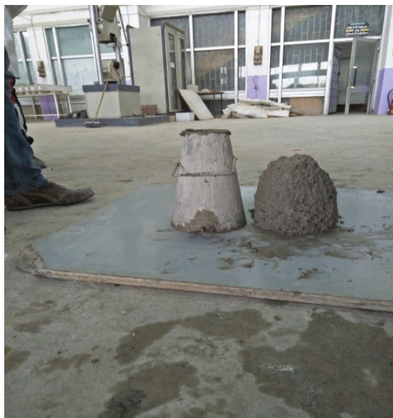
Figure II.11 Essai d'affaissement au cône d'Abrams
