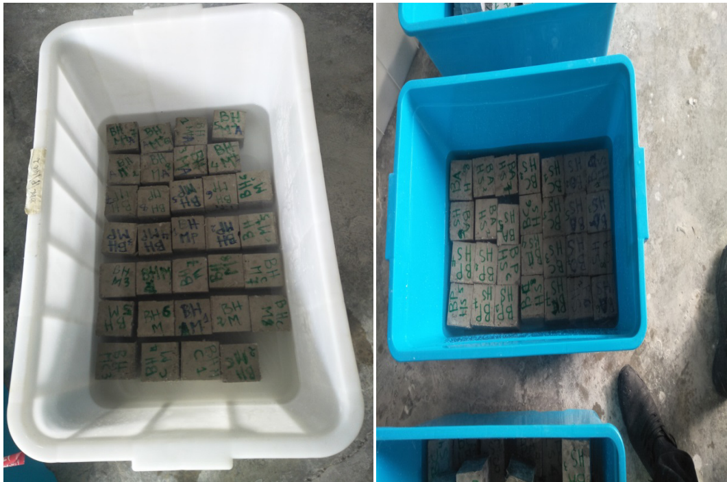
Figure IV.5 Immersion des échantillons du bétons dans la solution saline
