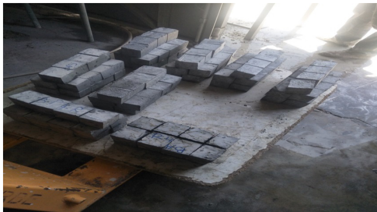
Figure IV.2 Cubes de 7x7x7 cm découpés à partir des éprouvettes 7x7x28 cm
