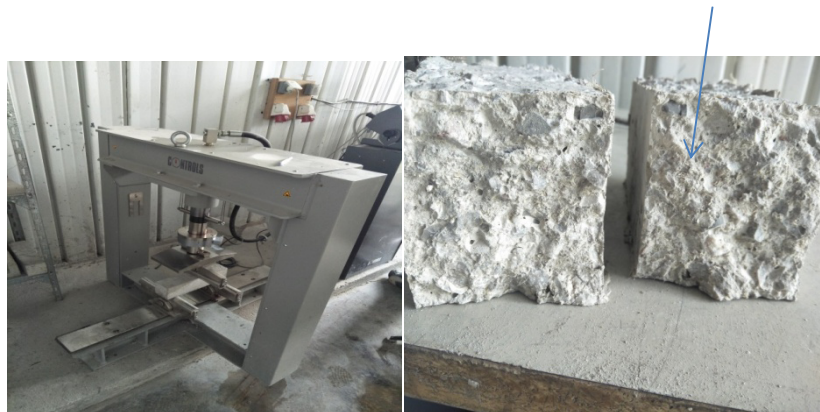
Figure III.5 Essais de traction par flexion réalisées sur le béton HC-0.25
