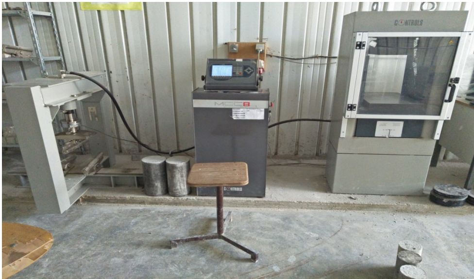
Figure II.12 Machine d'écrasement des différents essais
