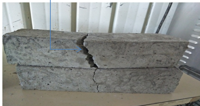
Figure III.6 Exemple de phénomène de couture des fibres d'alfa
