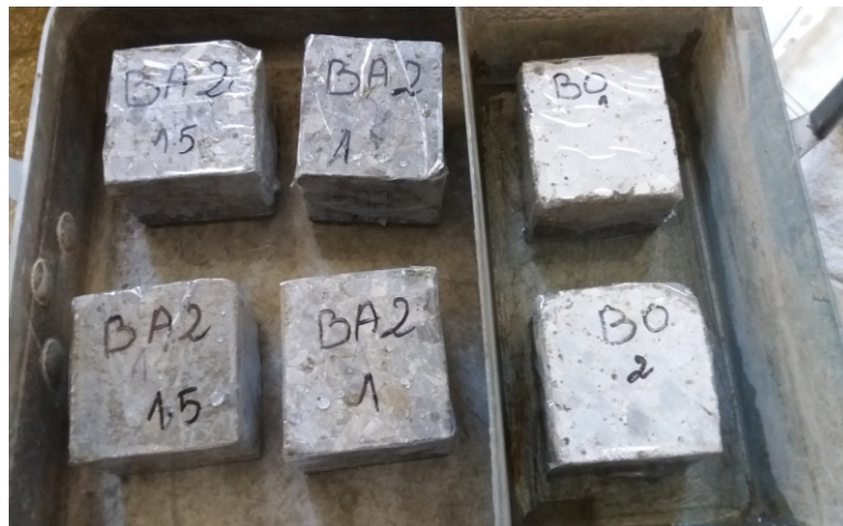
Figure II.15 Essai d'absorption capillaire.
