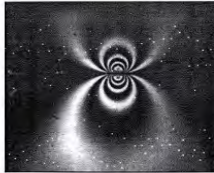
Fig. 16. Image de photoélasticité qui montre le champ de déformation D'un contact cylindre - cylindre.
