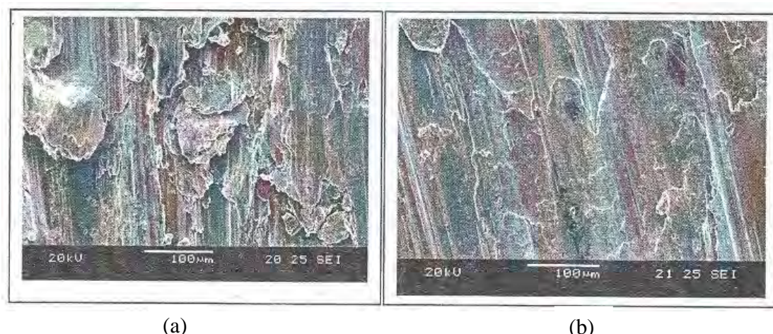
Fig. 14. Microanalyse X de l'échantillon ayant frotté durant 30 [mn], v=0,38 [m/s] , pour (a) N=94 [N] et (b) N=157 [N] , d'après [16].
