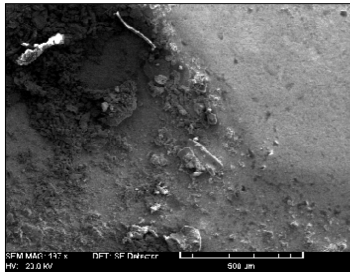
Figure 14a : Morphologie du cratère montrant un lit de débris de matière adhérente constituant le troisième corps P25+TiC; gx197
