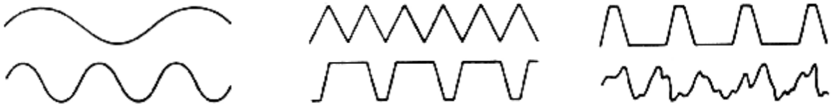
Figure 13 : Surfaces dont les R_a sont identiques
