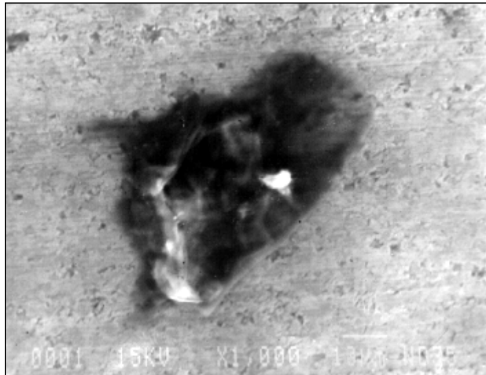
Figure 8a : Formation de micro-cavités autour du troisième corps
