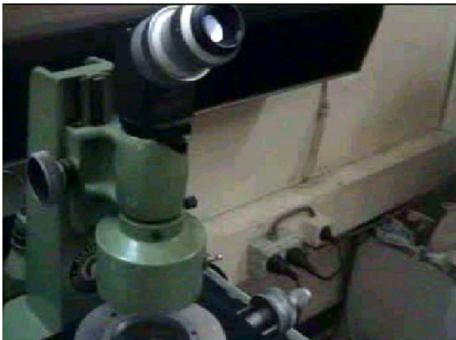
Figure 2.1 : Microscope d'atelier. Mesure de l'usure frontale
