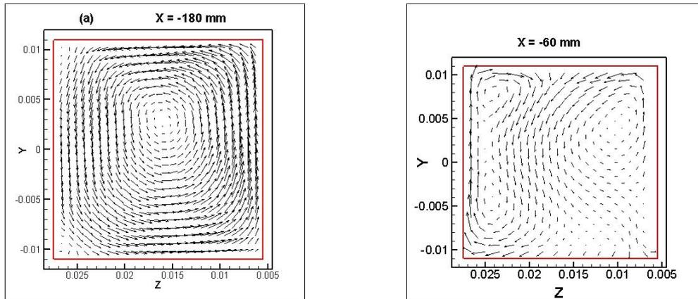
Figure 3.14 Champs de vecteurs vitesse à la sortie du coude et près de la sortie du conduit
