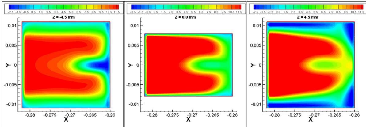
Figure 3.18 Contours de la composante de vitesse, suivant z, dans le coude
