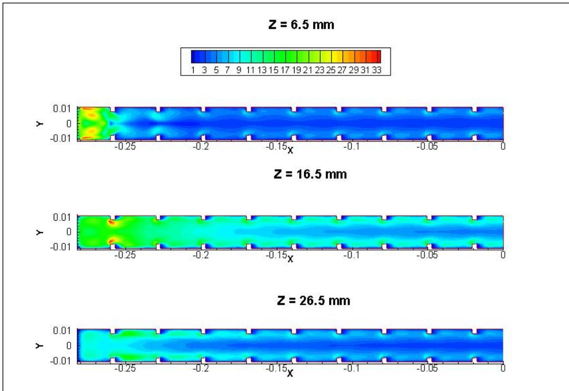
Figure 3.29 Contours de l'énergie cinétique turbulente dans la 2<sup>ème</sup> passe
