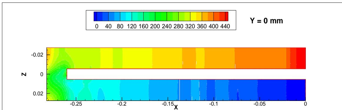
Figure 3.22 Distribution de pression statique à  $y = 0 mm$
