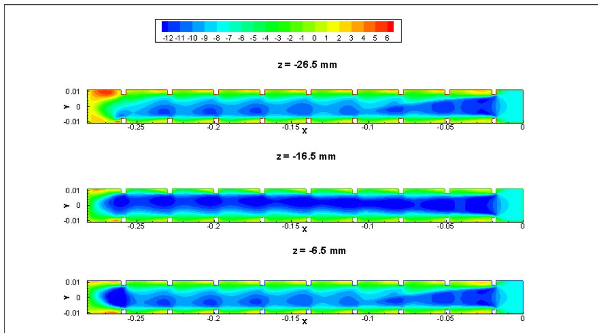
Figure 3.31 Contours de vitesse longitudinale dans la 1<sup>ère</sup> passe
