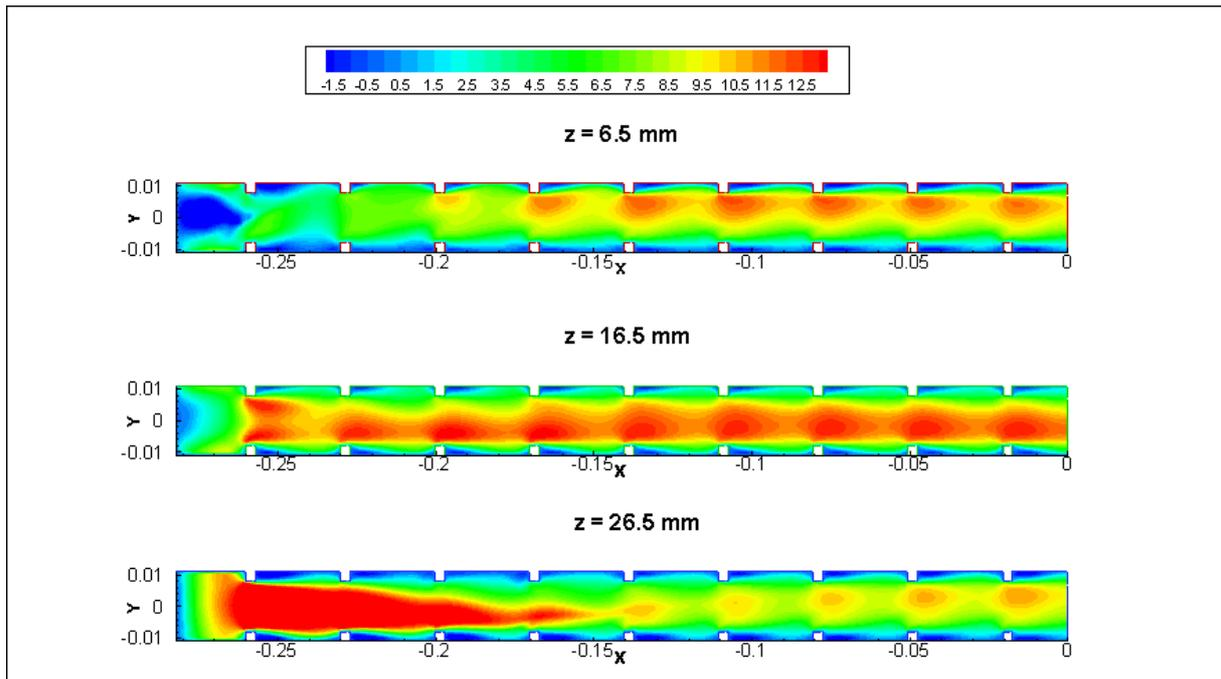
Figure 3.32 Contours de vitesse longitudinale dans la 2<sup>ème</sup> passe
