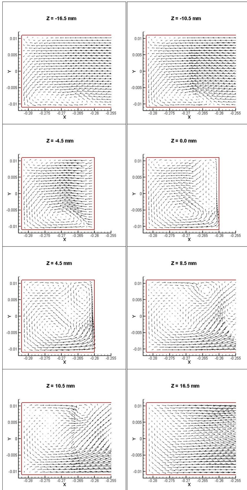
Figure 3.13 Evolution des cellules contra rotatives dans le coude à 180°
