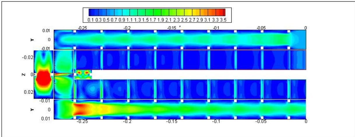
Figure 3.27 Distribution du coefficient de frottement local
