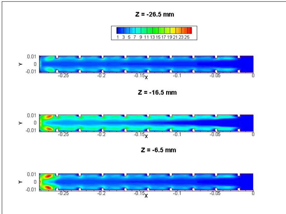
Figure 3.28 Contour de l'énergie cinétique turbulente dans la 1<sup>ère</sup> passe
