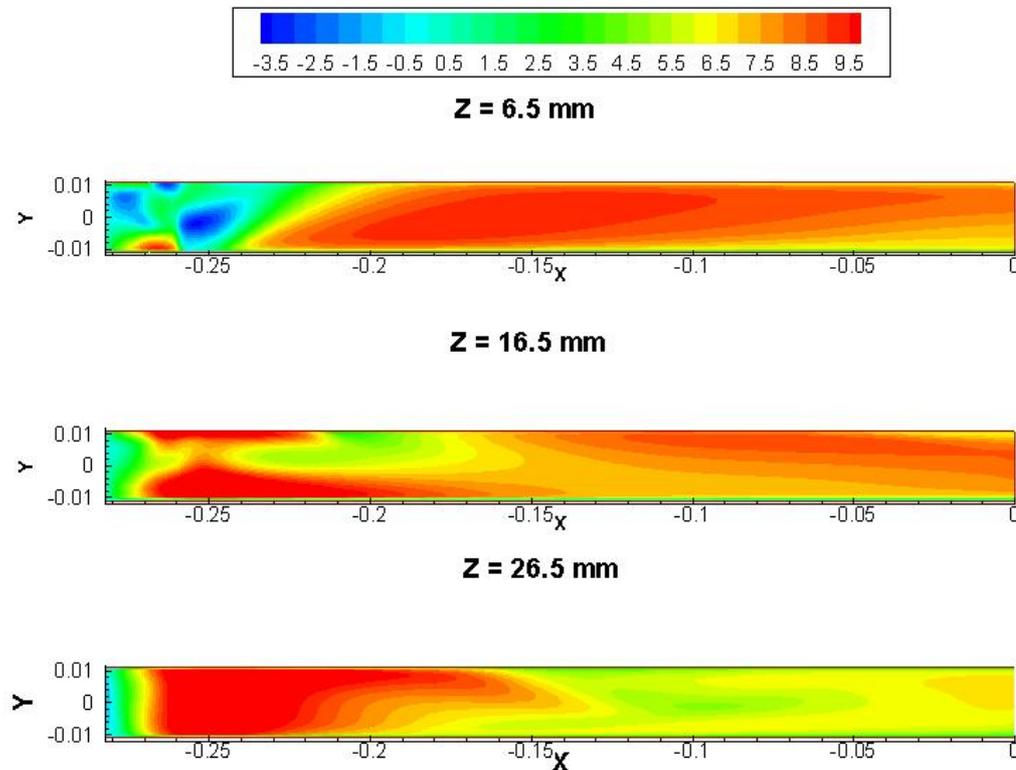
Figure 3.16 Contours de vitesse longitudinale dans la 2<sup>ème</sup> passe
