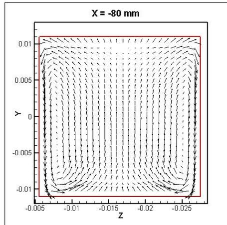
Figure 3.11 Formation des cellules contra rotatives dans la 1<sup>ère</sup> passe
