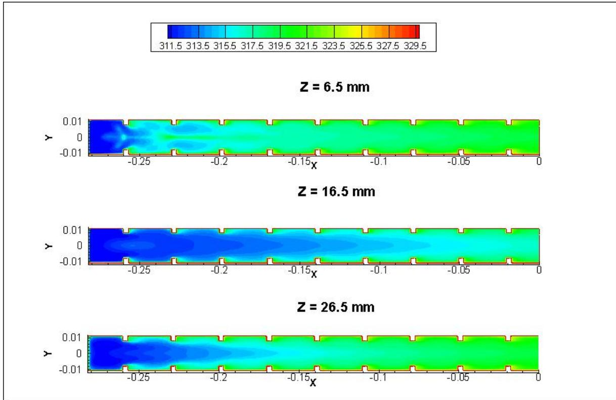
Figure 3.25 Distribution de température statique dans la 2<sup>ème</sup> passe du canal
