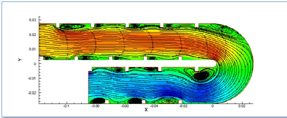
Figure 3.6. Lignes de courant et zones de recirculation sur le plan de symétrie.
