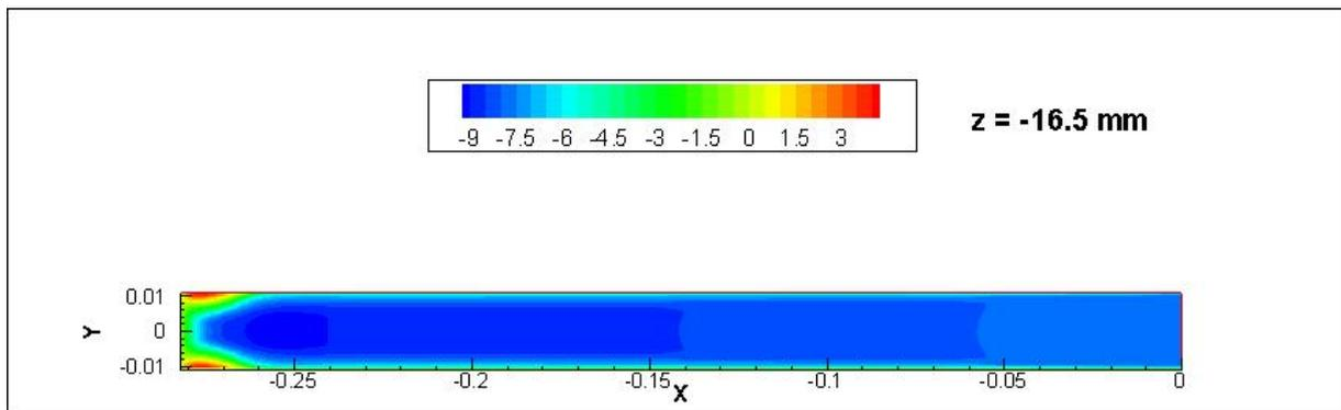
Figure 3.8 Contours de vitesse longitudinale dans la 1<sup>ère</sup> passe
