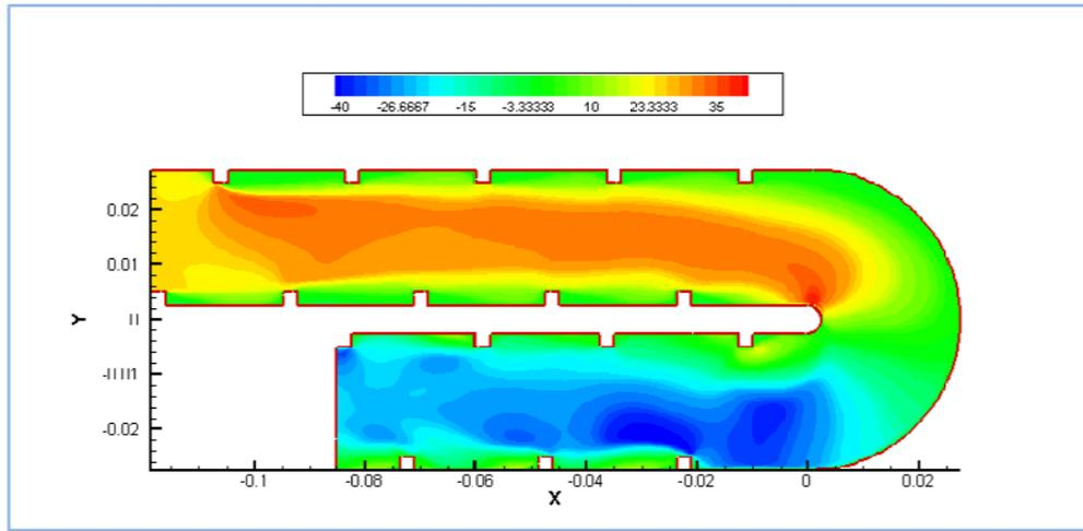
Figure 3.5. Contour de la vitesse axiale sur la plan de symétrie.
