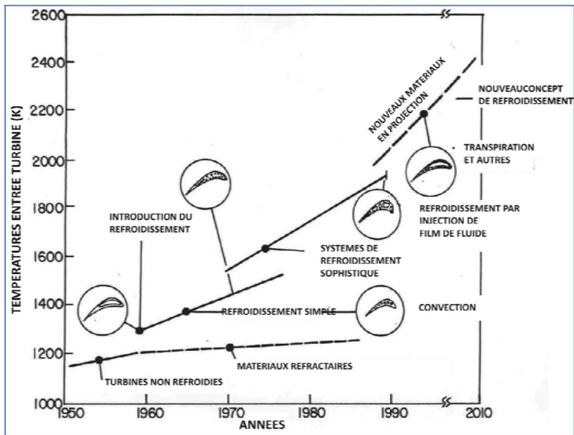
Fig. 1.2. Température d'entrée turbine (Copyright Rolls Royce plc).
