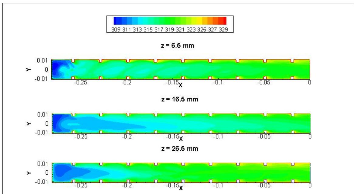
Figure 3.38 Champ de température dans la 2<sup>ème</sup> passe
