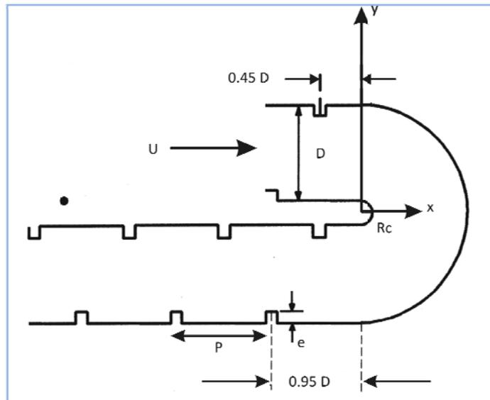
Figure 3.1 Conduit en U à nervures alternées
