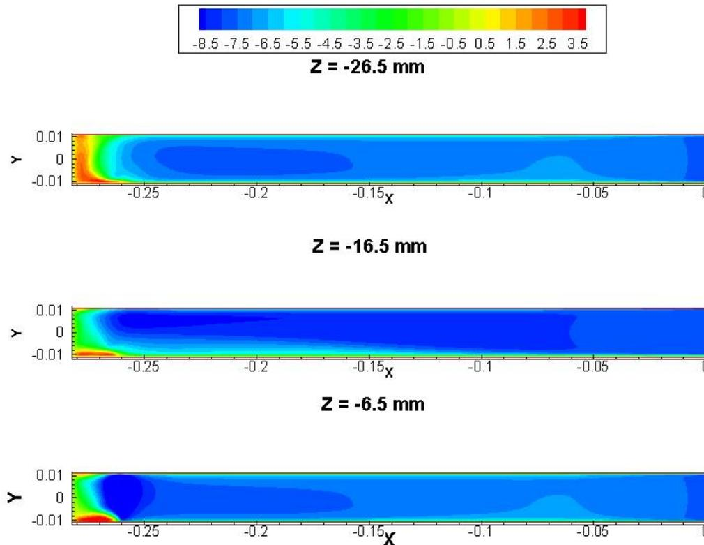
Figure 3.15 Contours de vitesse longitudinale dans la 1<sup>ère</sup> passe
