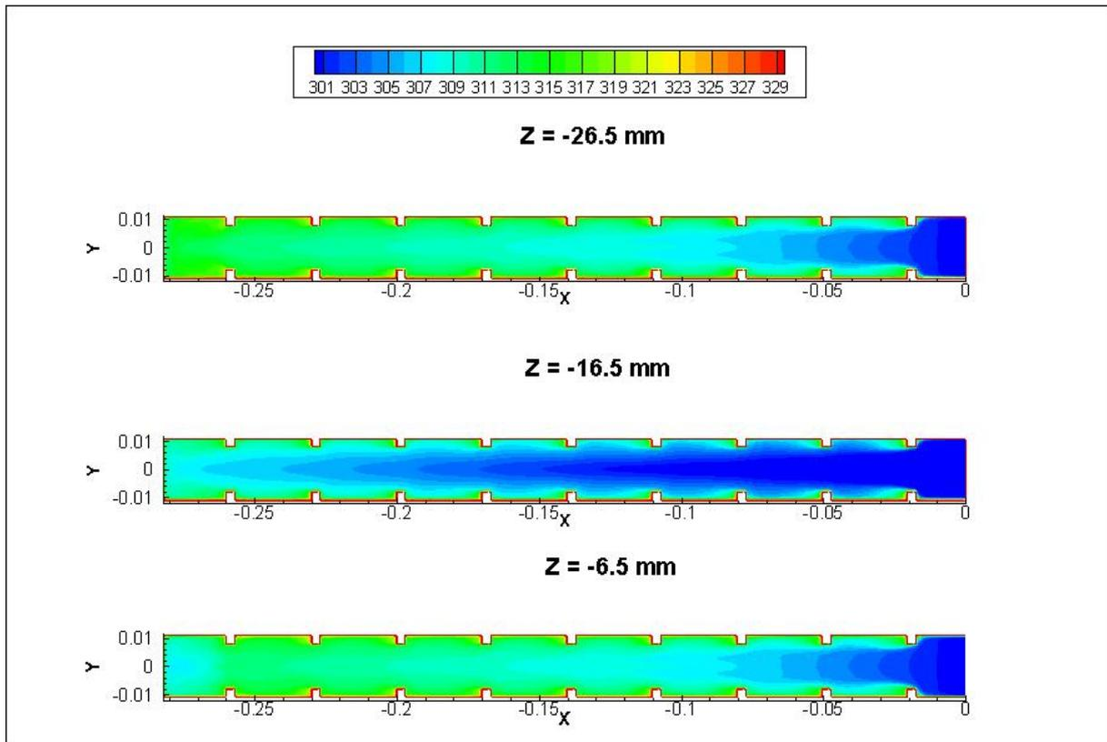
Figure 3.24 Distribution de température statique dans la 1<sup>ère</sup> passe du canal
