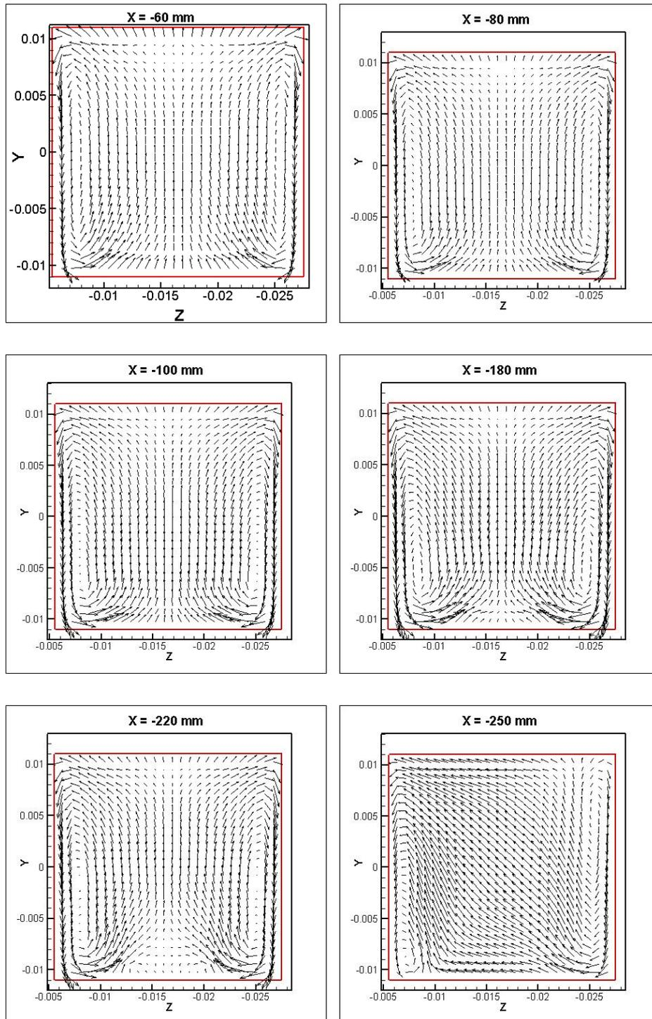
Figure 3.12 Evolution des cellules contra rotatives dans la 1<sup>ère</sup> passe
