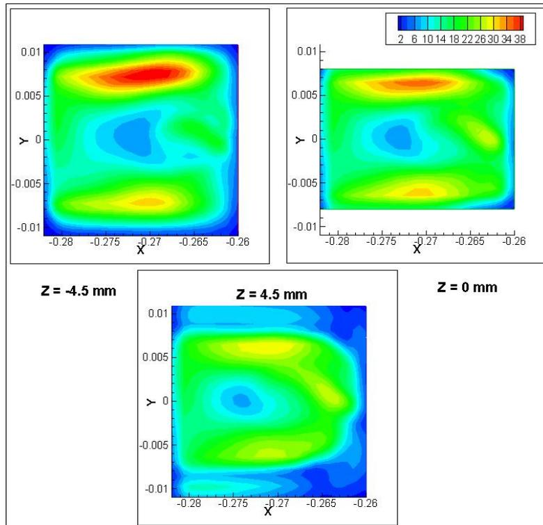
Figure 3.44 Energie cinétique turbulente à travers le coude
