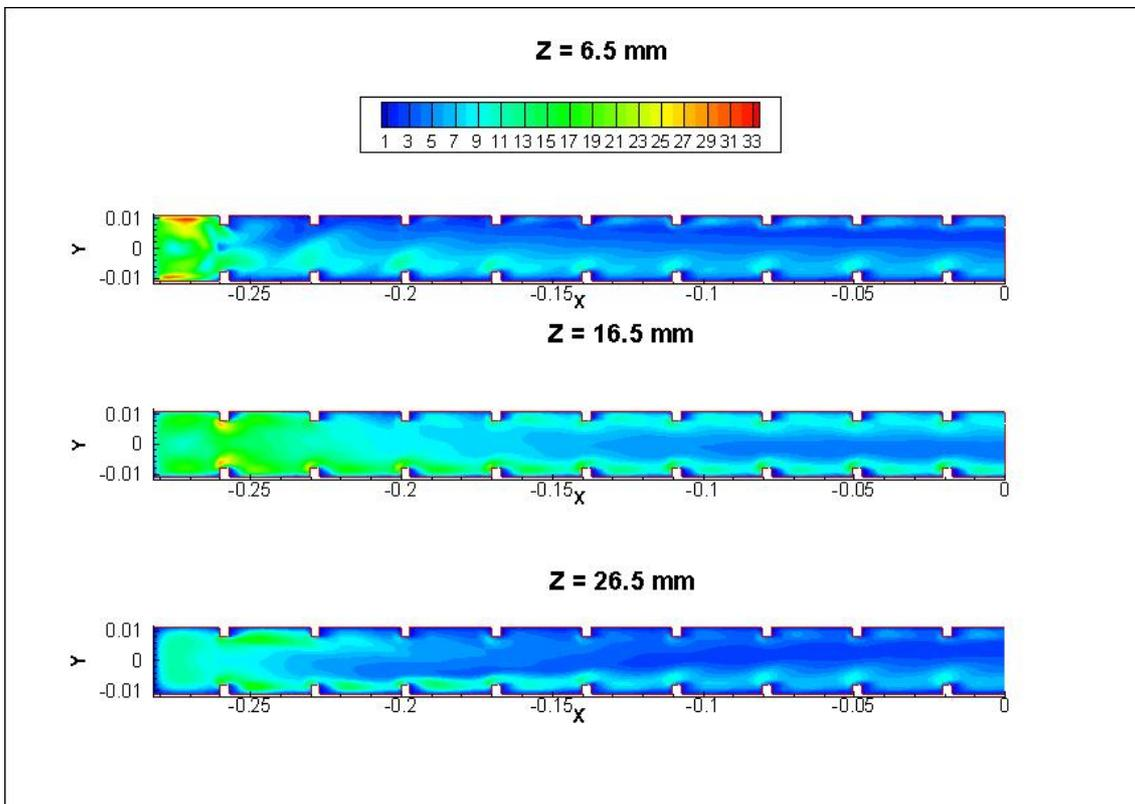
Figure 3.43 Distribution de l'énergie cinétique dans la 2<sup>ème</sup> passe
