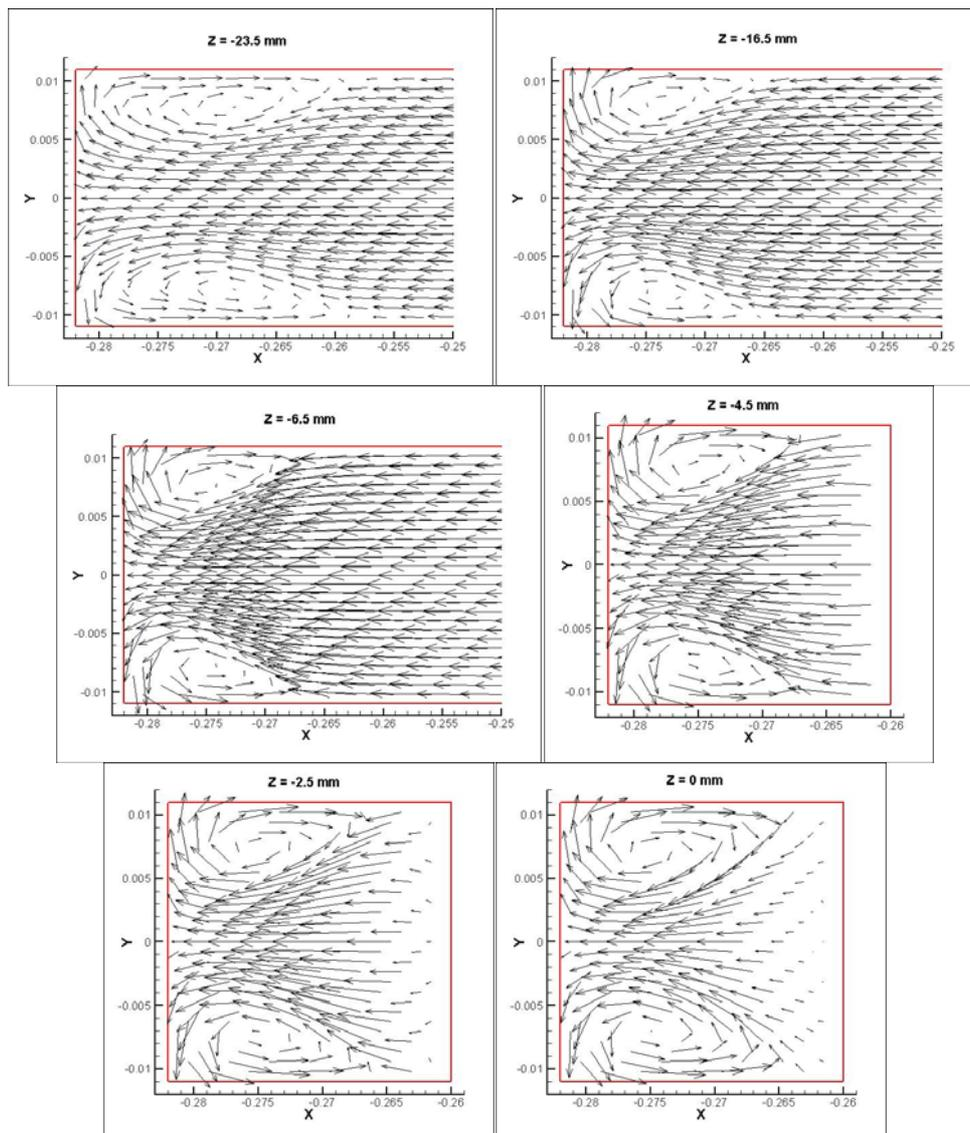
Figure 3.10 Evolution des cellules contra rotatives dans le coude
