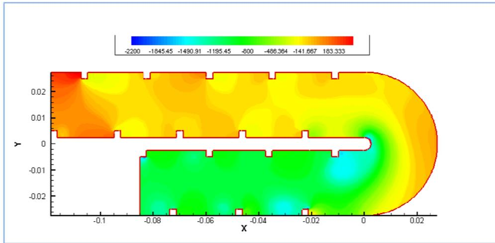
Figure 3.4. Champ de pression au niveau du plan de symétrie du conduit
