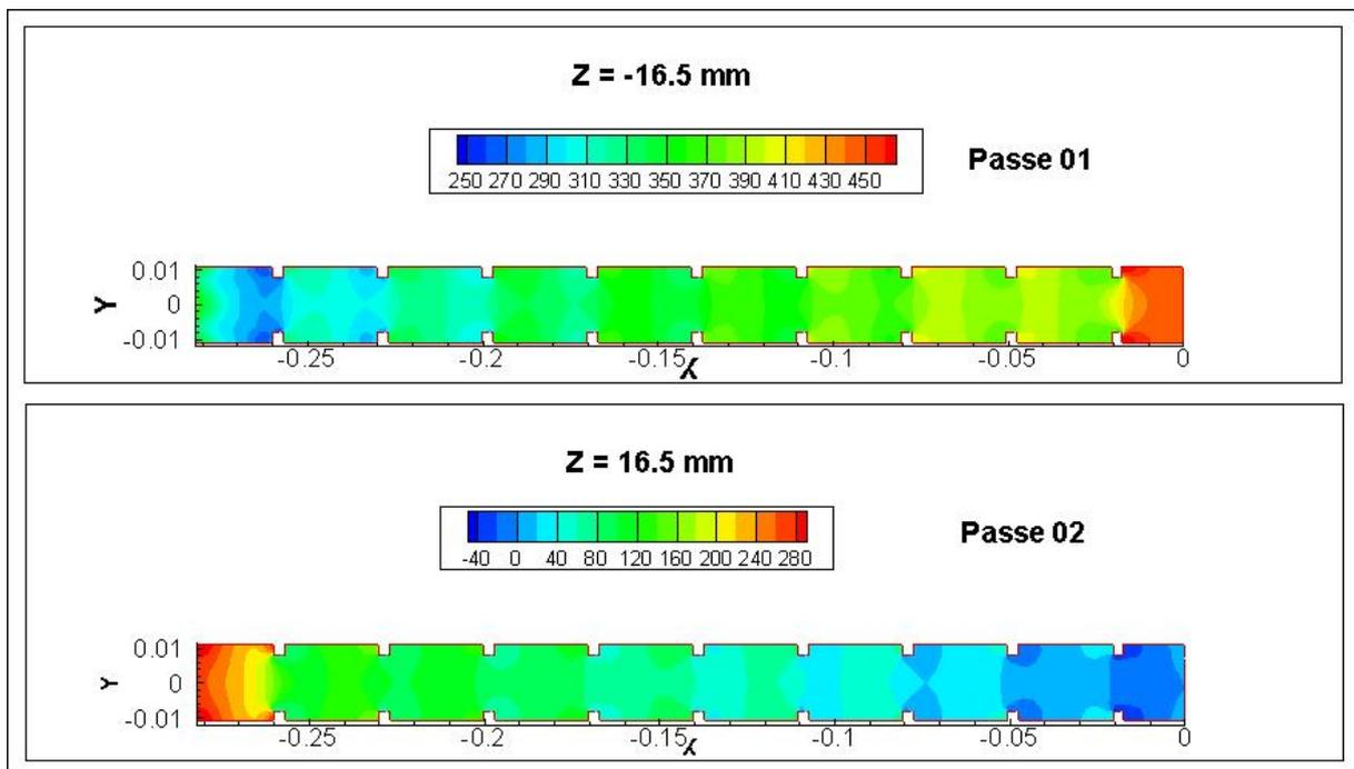
Figure 3.23 Contours de pression statique dans les plans médians  $XY$  dans les deux passes
