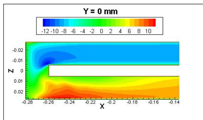
Figure 3.9 Contours de vitesse longitudinale dans le plan  $y = 0$
