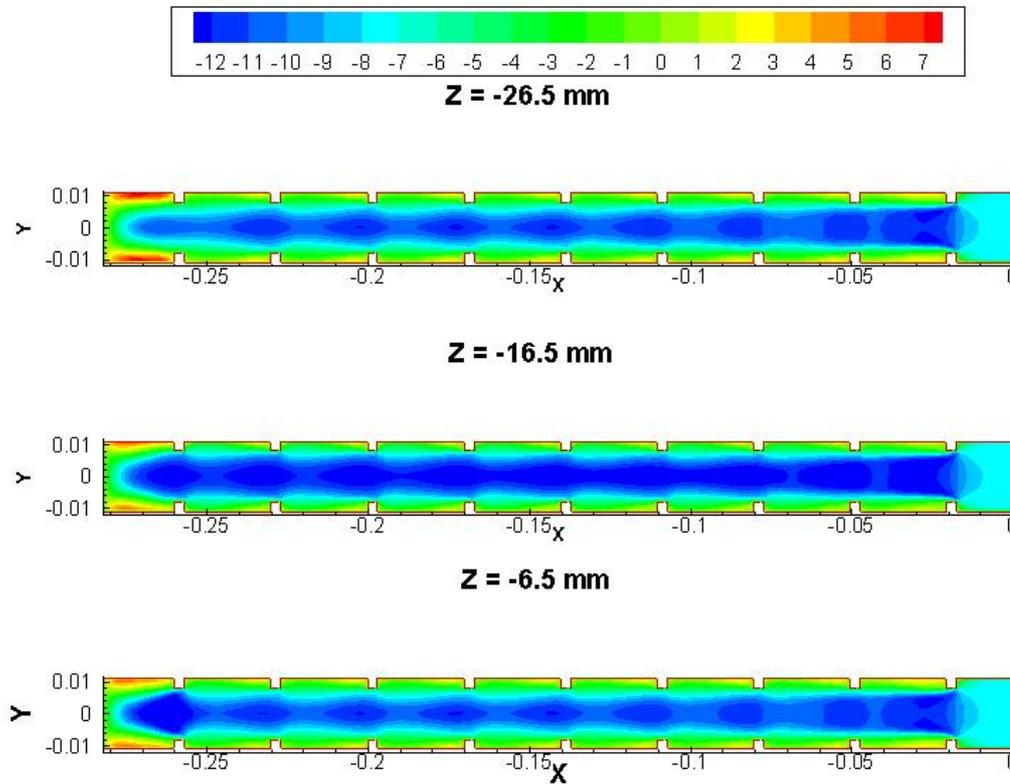
Figure 3.17 Contours de vitesse longitudinale dans la 1<sup>ère</sup> passe
