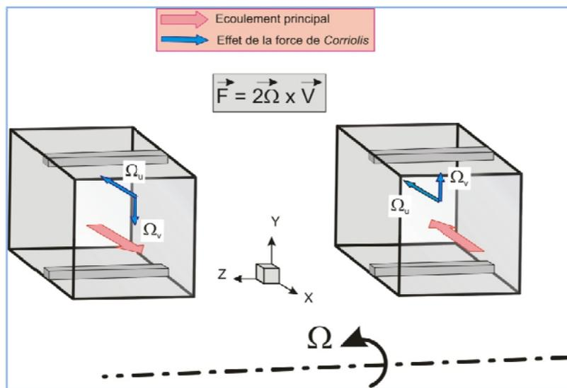
Fig. 2.1 Effet de la force de *Coriolis* sur un conduit en rotation
