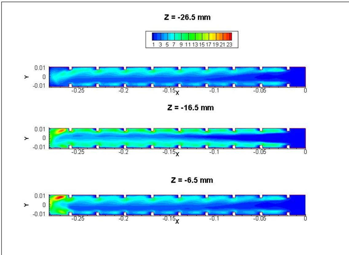
Figure 3.42 Distribution de l'énergie cinétique dans la 1<sup>ère</sup> passe
