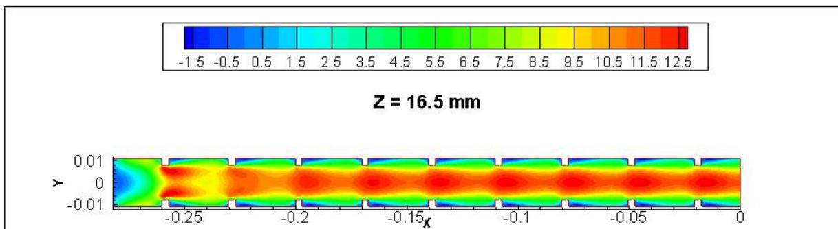
Figure 3.20 Contours de vitesse longitudinale dans la 2<sup>ème</sup> passe et périodicité
