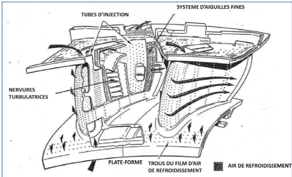
Fig. 1.3 Schémas de refroidissement (Copyright Rolls Royce plc).
