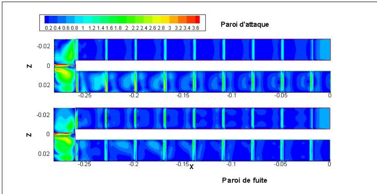
Figure 3.41 Coefficient de frottement local sur la paroi d'attaque/de fuite
