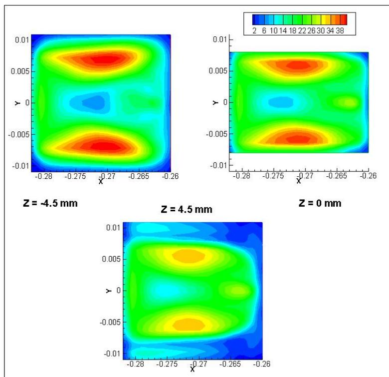
Figure 3.30 Energie cinétique turbulente dans le coude
