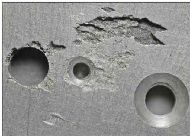
FIGURE 2.1 : Corrosion autour des trous de fixation induisant la nucléation des fissures.
