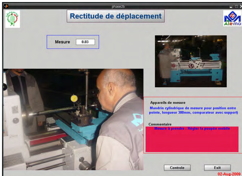
Figure IV-8 : Exécution d'une entrée de côtes hors tolérances.
