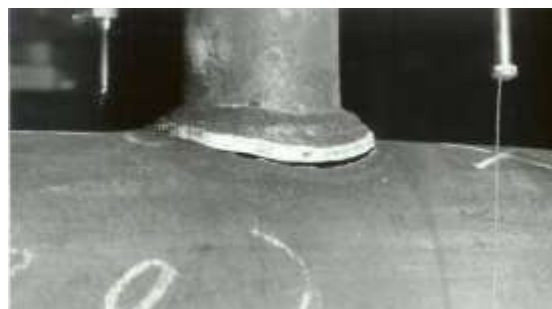
(b) Cisaillement par poinçonnement de la membrure
