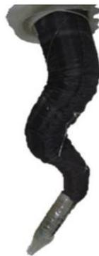
Figure 1.15 : Le manipulateur continuum actionnés par tendons et pression.
