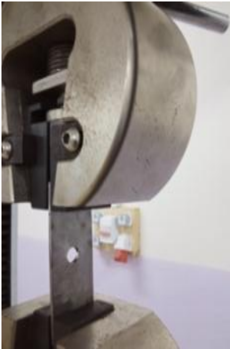
Fig. V.2a : Machine d'essai de traction électronique 100KN
